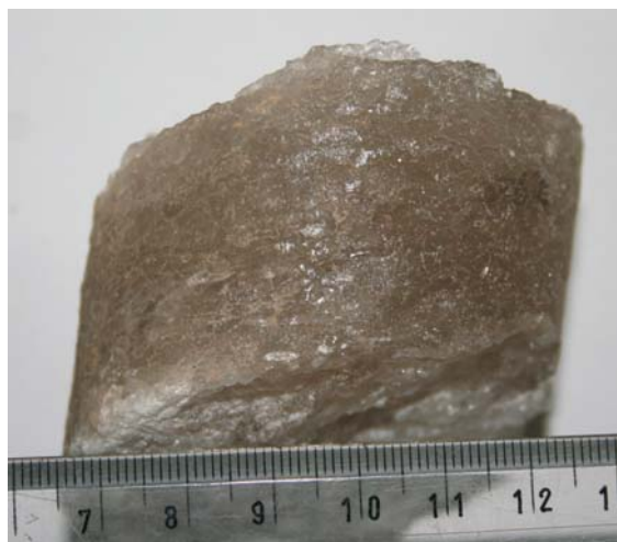
Fig. 6. Sole drobno- i średniokrystaliczne z wydłużonymi kryształami halitu
