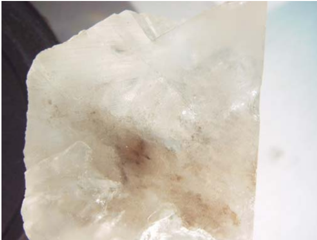
Fig. 5. Duże kryształy halitu w solach grubokrystalicznych i kryształowych z nieregularną smugą o ciemniejszym zabarwieniu złożoną z drobniejszych kryształów halitu Fig. 5. Big halite crystals in coarse-grained and crystal-grained salts with irregular, grey streak consist of smaller halite crystals
