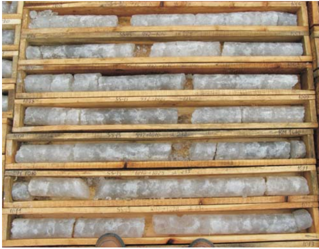
Fig. 4. Sole grubokrystaliczne i kryształowe Fig. 4. Coarse-grained and crystal-grained salts
