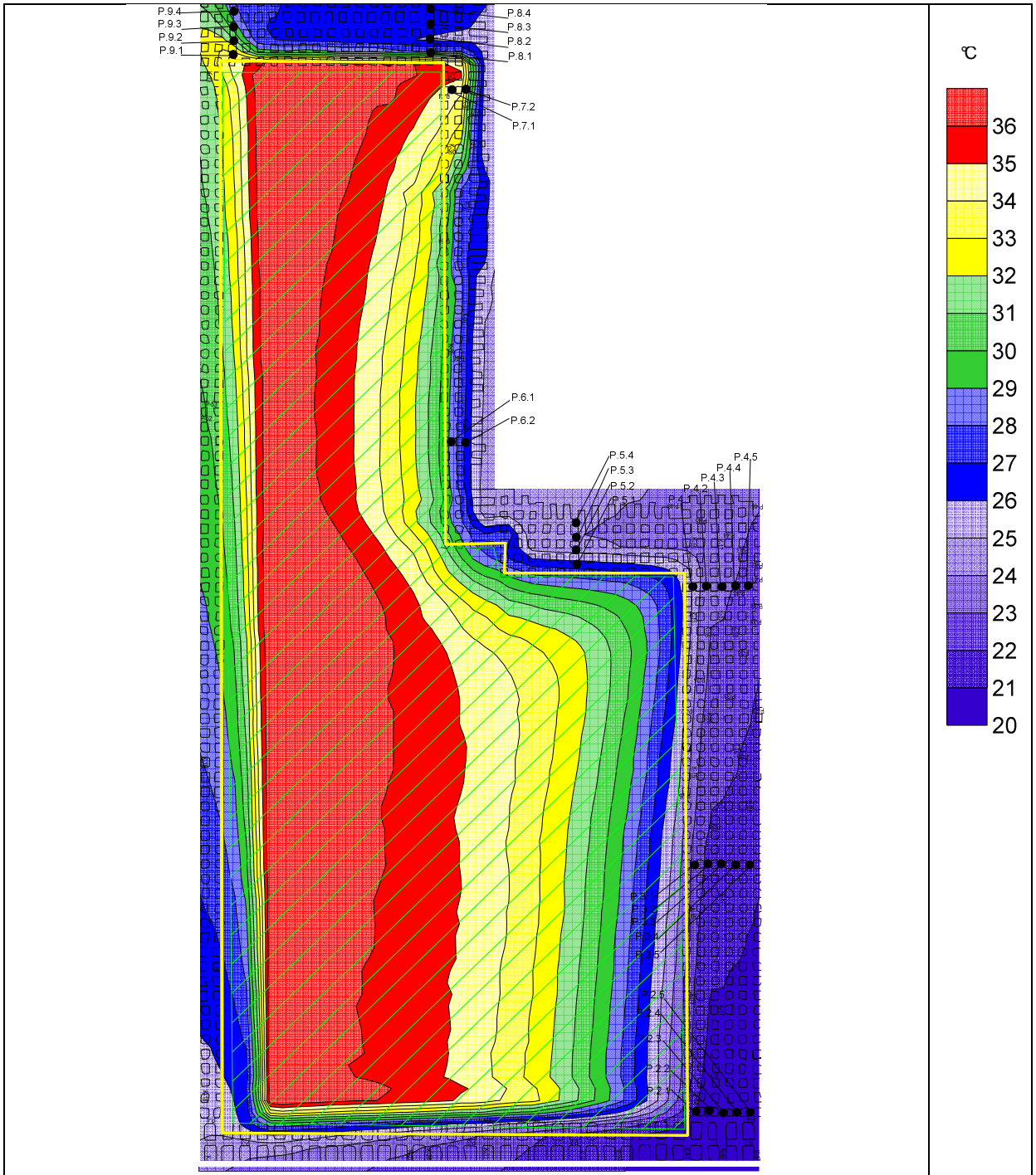
Rys. 5.27. Rozkład temperatur w oddziale górniczym G-61 blok C-II dla wariantu T.09
