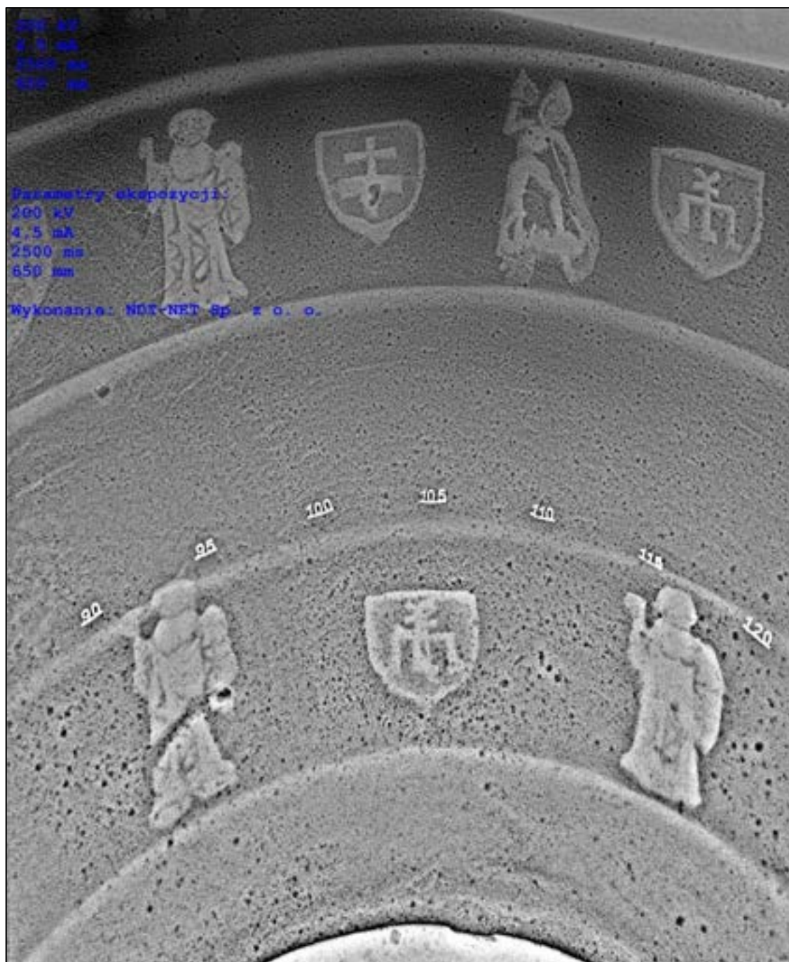
Rys. 8.70. Zdjęcie rtg czaszy chrzcielnicy z kościoła św. Szczepana. Parametry ekspozycji: napięcie 200 kV, natężenie prądu 4,5 mA, czas 2500 ms
