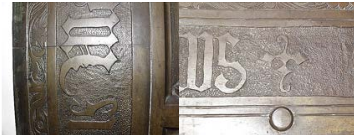
Rys. 9.15. Płyta Piotra Kmity w katedrze na Wawelu, liternictwo wykonane techniką odlewniczą i techniką cyzelowania [Fot. A. Garbacz-Klempka]
