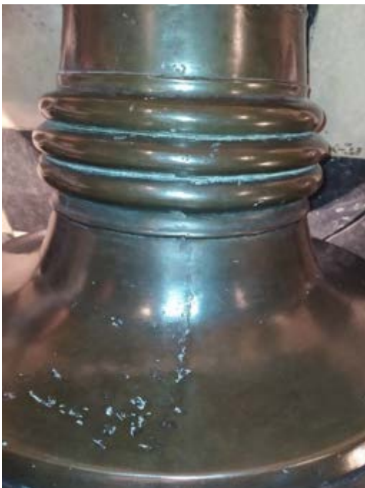
Rys. 8.80. Widoczna płaszczyzna podziału podstawy chrzcielnicy [Fot. A. Garbacz-Klempka]
