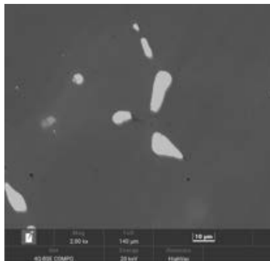
Rys. 9.39. Obraz elektronowy 4Q-BSE COMPO stopu M2, pow. 2000x
