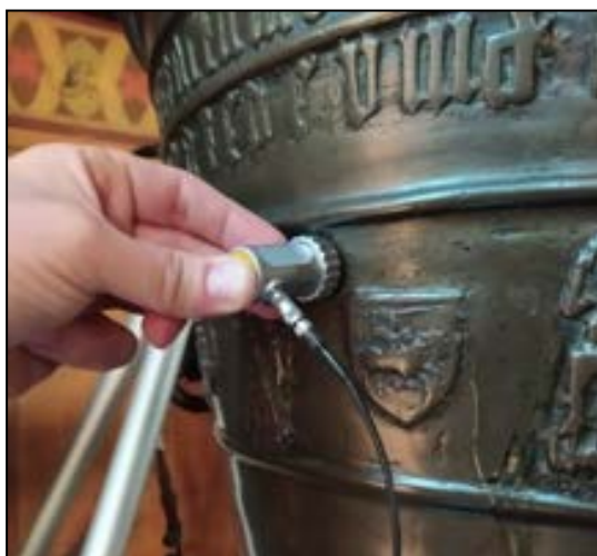
Rys. 8.3. Fotografie przedstawiające defektoskop Krautkrämer USM 36 w trakcie badań chrzcielnicy w kościele św. Szczepana [fot. A. Garbacz-Klempka]
