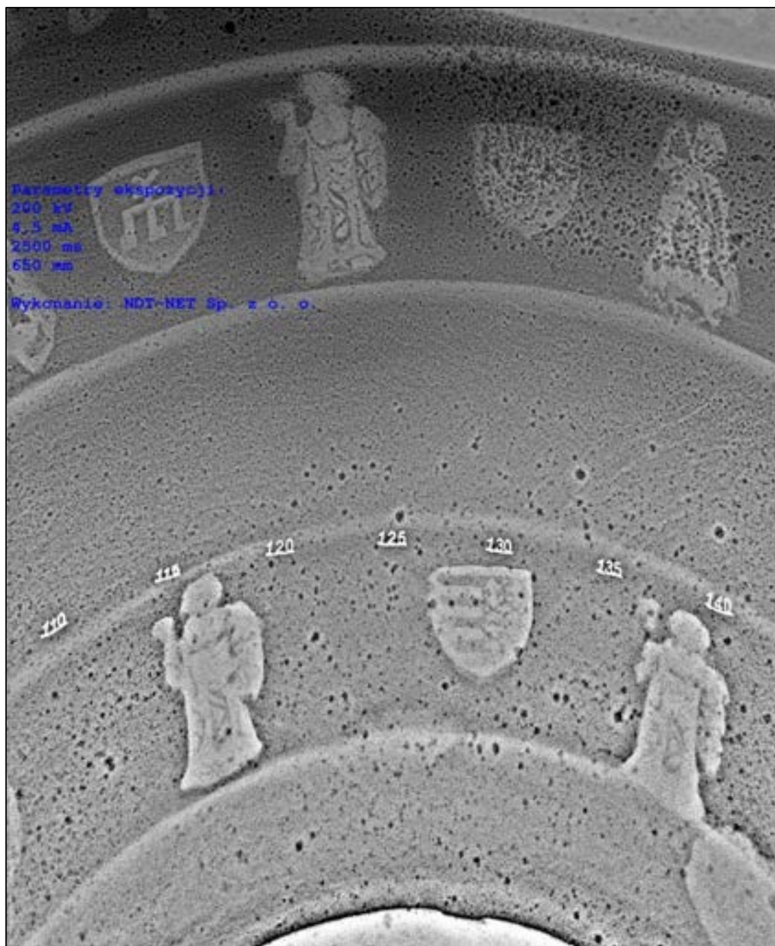
Rys. 8.71. Zdjęcie rtg czaszy chrzcielnicy z kościoła św. Szczepana. Parametry ekspozycji: napięcie 200 kV, natężenie prądu 4,5 mA, czas 2500 ms
