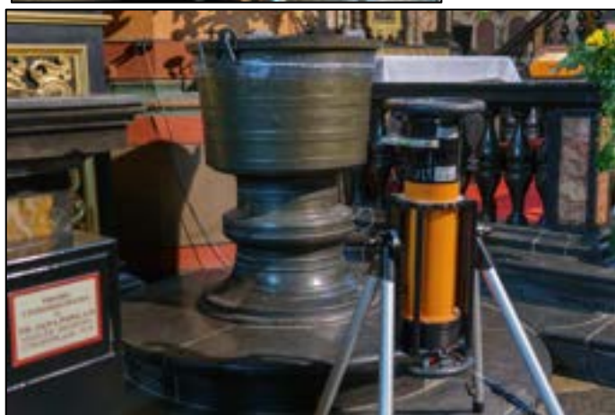
Rys. 8.2. Fotografie przedstawiające aparat rentgenowski ERESKO MF4 w trakcie badań w kościele Mariackim [fot. A. Mikołajska]
