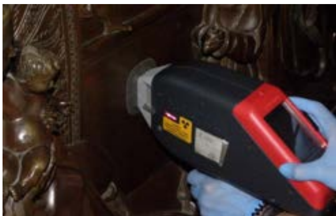
Rys. 9.26. Badania spektrometryczne płyty kardynała Fryderyka Jagiellończyka w Katedrze w Wawelu [Fot. A. Garbacz-Klempka]
