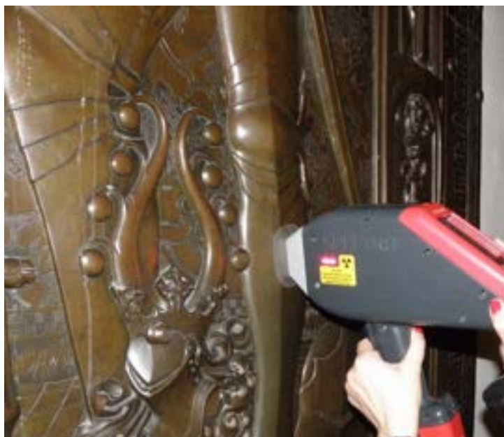
Rys. 9.18. Badania składu chemicznego płyty Piotra Kmity w katedrze na Wawelu [Fot. A. Garbacz-Klempka]
