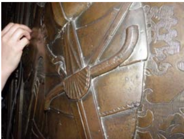
Rys. 9.19. Badania grubości płyty Piotra Kmity w katedrze na Wawelu [Fot. A. Garbacz-Klempka]
