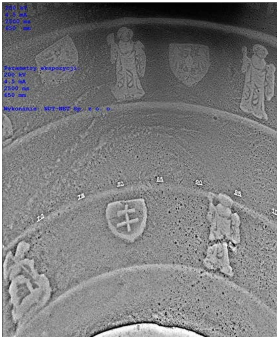
Rys. 8.69. Zdjęcie rtg czaszy chrzcielnicy z kościoła św. Szczepana. Parametry ekspozycji: napięcie 200 kV, natężenie prądu 4,5 mA, czas 2500 ms
