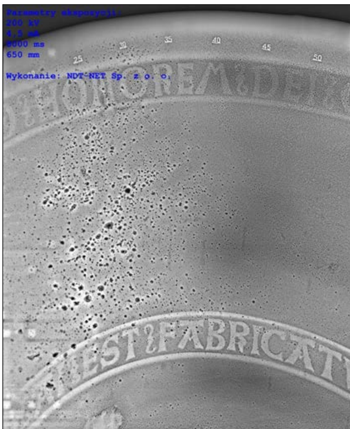
Rys. 8.83. Zdjęcie rtg czaszy chrzcielnicy z kościoła św. Mikołaja. Parametry ekspozycji: napięcie 200 kV, natężenie prądu 4,5 mA, czas 8000 ms
