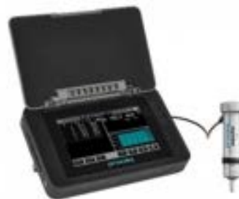
Rys. 8.4. Equotip - Przenośny twardościomierz metodami Leeb'a, Rockwell & UCI [87]
