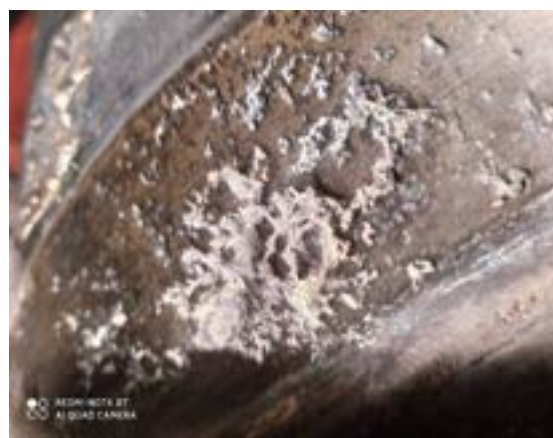
Rys. 8.60. Czasza chrzcielnicy w kościele św. Szczepana, wady powierzchni [Fot. A. Garbacz-Klempka]
