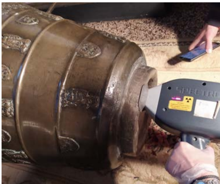
Rys. 8.61. Czasza chrzcielnicy w kościele św. Szczepana w trakcie analizy składu chemicznego metodą XRF [Fot. A. Garbacz-Klempka]
