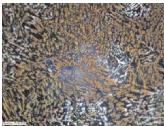
Rys. 8.24. Powierzchnia próbki S0 po badaniach korozyjnych, pow. 200x
