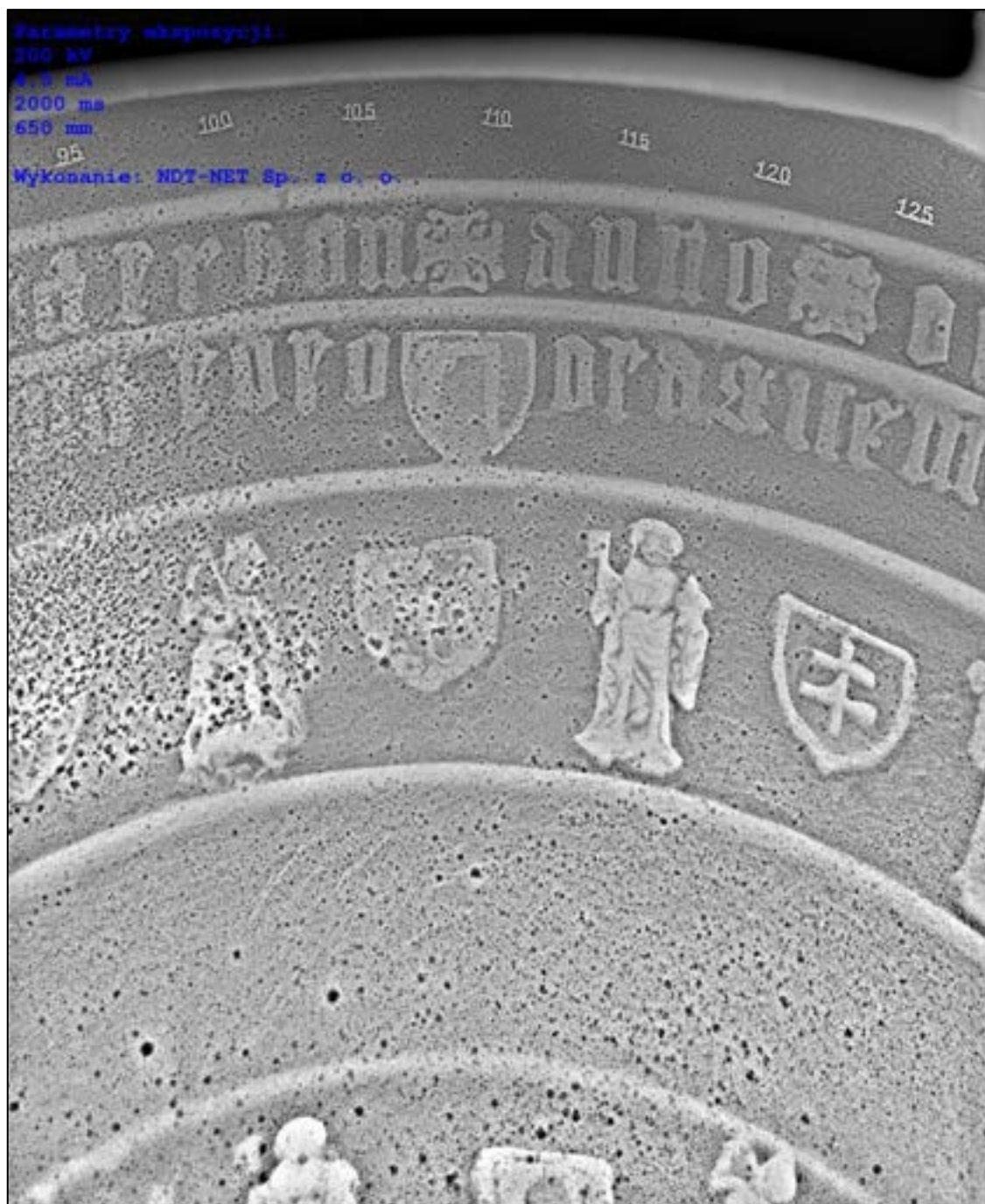
Rys. 8.76. Zdjęcie rtg czaszy chrzcielnicy z kościoła św. Szczepana. Parametry ekspozycji: napięcie 200 kV, natężenie prądu 4,5 mA, czas 2000 ms
