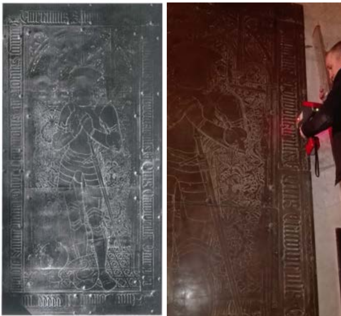
Rys. 9.3. Fotografia przedstawiająca płytę Emmerama Salomona w kościele Mariackim w Krakowie i płyta w trakcie badań spektroskopii fluorescencji rentgenowskiej [6, Fot. Aldona Garbacz-Klempka]
