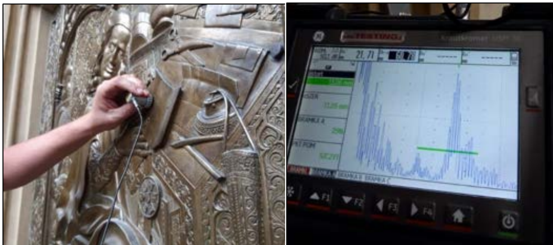
Rys. 9.29. Fotografie przedstawiające badania grubości odlewu z wykorzystaniem defektoskopii ultradźwiękowej w trakcie badań płyty Kallimacha w kościele Dominikanów
