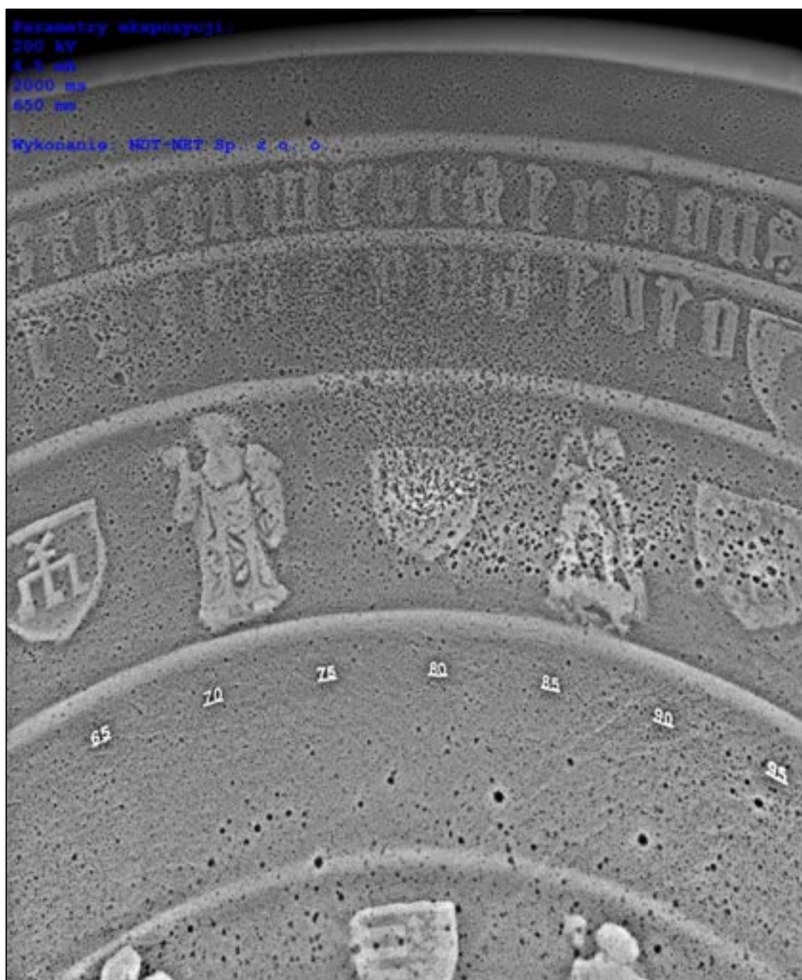
Rys. 8.65. Zdjęcie rtg czaszy chrzcielnicy z kościoła św. Szczepana. Parametry ekspozycji: napięcie 200 kV, natężenie prądu 4,5 mA, czas 2000 ms
