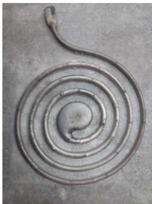
Rys. 8.21. Spiralna próba lejności stopu modelowego M1
