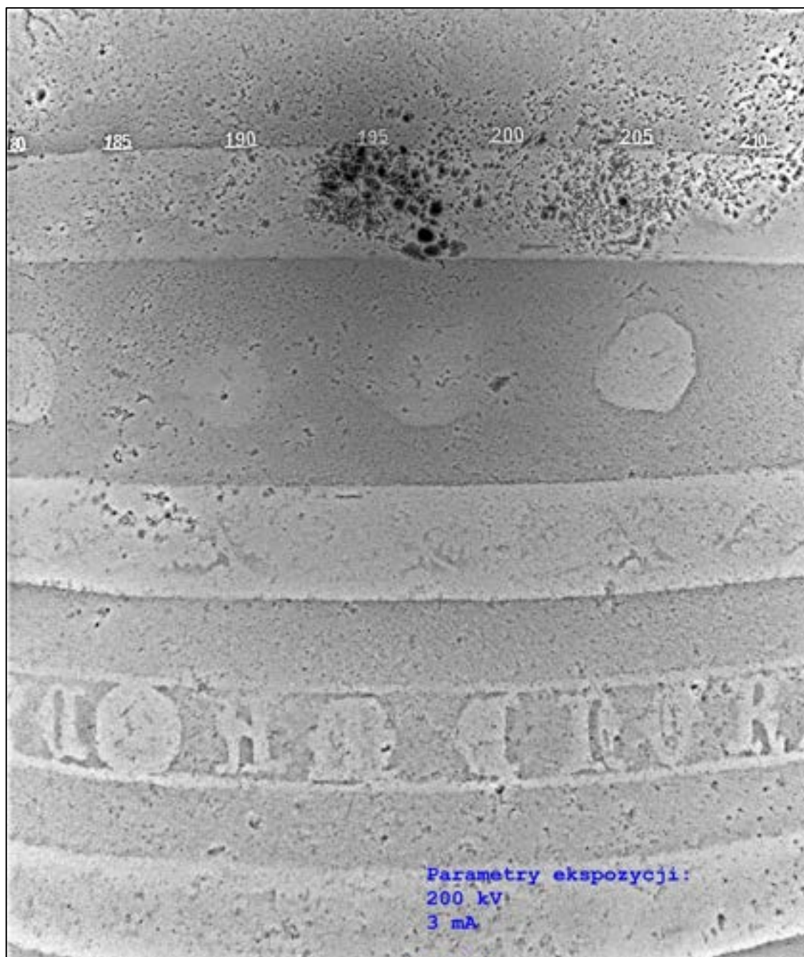
Rys. 8.13. Zdjęcie rtg czaszy chrzcielnicy z kościoła Mariackiego. Parametry ekspozycji: napięcie 200 kV, natężenie prądu 4,5 mA, czas 2000 s
