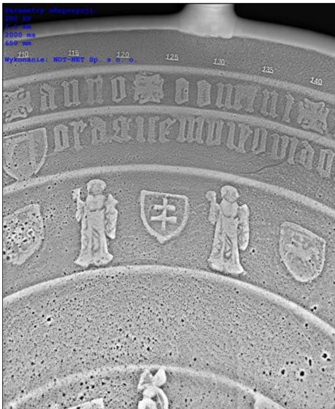
Rys. 8.75. Zdjęcie rtg czaszy chrzcielnicy z kościoła św. Szczepana. Parametry ekspozycji: napięcie 200 kV, natężenie prądu 4,5 mA, czas 2000 ms
