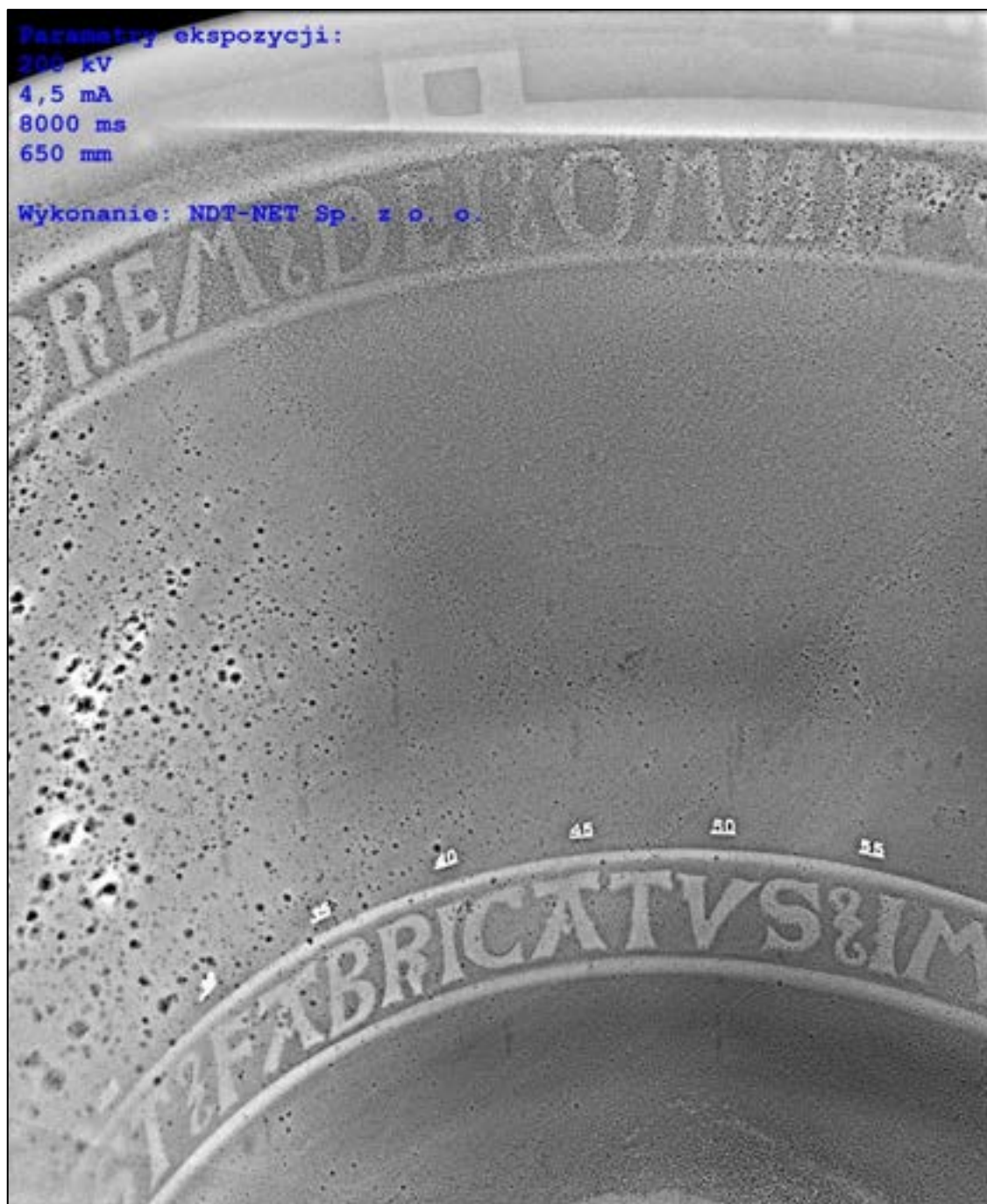
Rys. 8.91. Zdjęcie rtg czaszy chrzcielnicy z kościoła św. Mikołaja. Parametry ekspozycji: napięcie 200 kV, natężenie prądu 4,5 mA, czas 8000 ms
