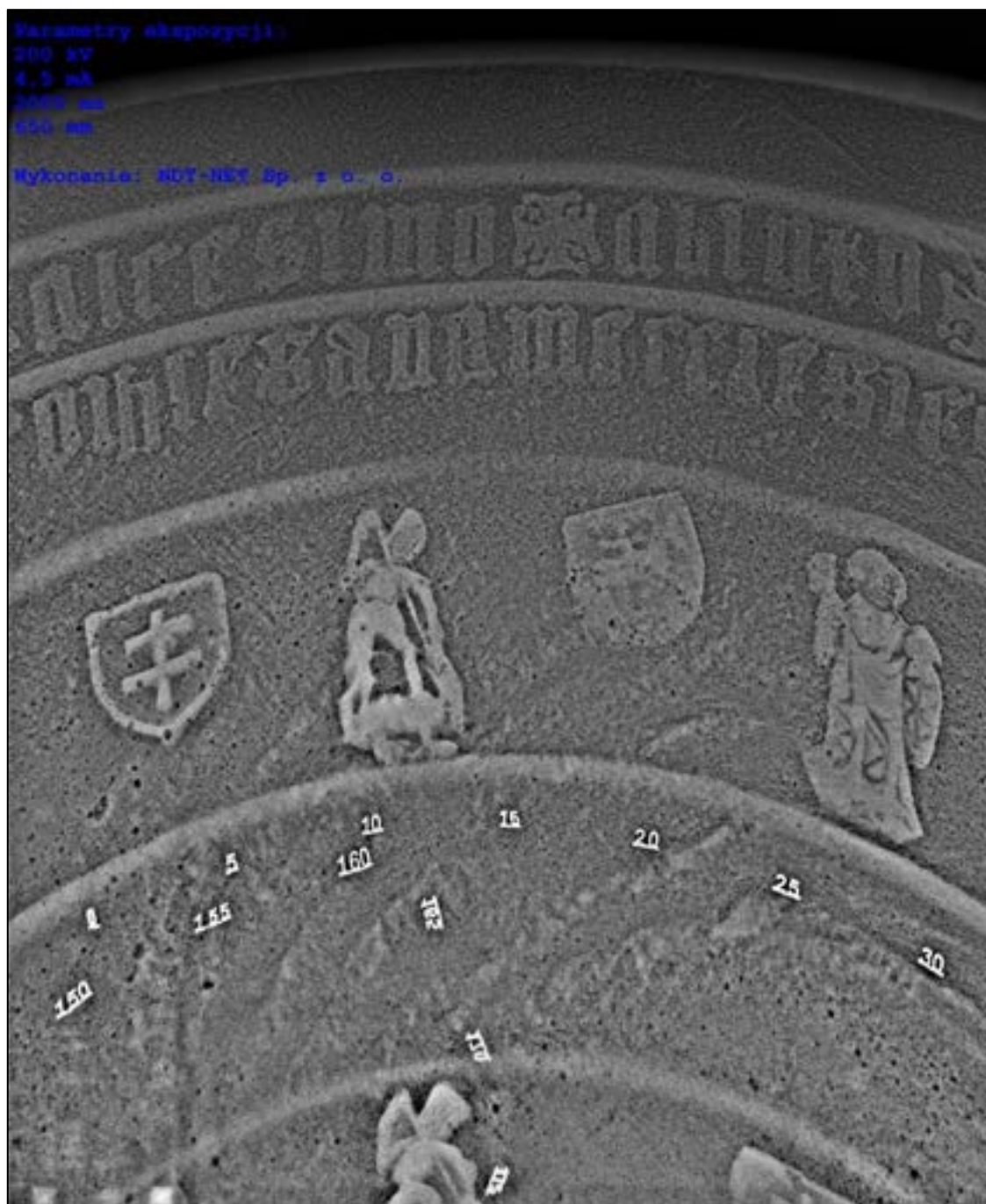
Rys. 8.63. Zdjęcie rtg czaszy chrzcielnicy z kościoła św. Szczepana. Parametry ekspozycji: napięcie 200 kV, natężenie prądu 4,5 mA, czas 2000 ms
