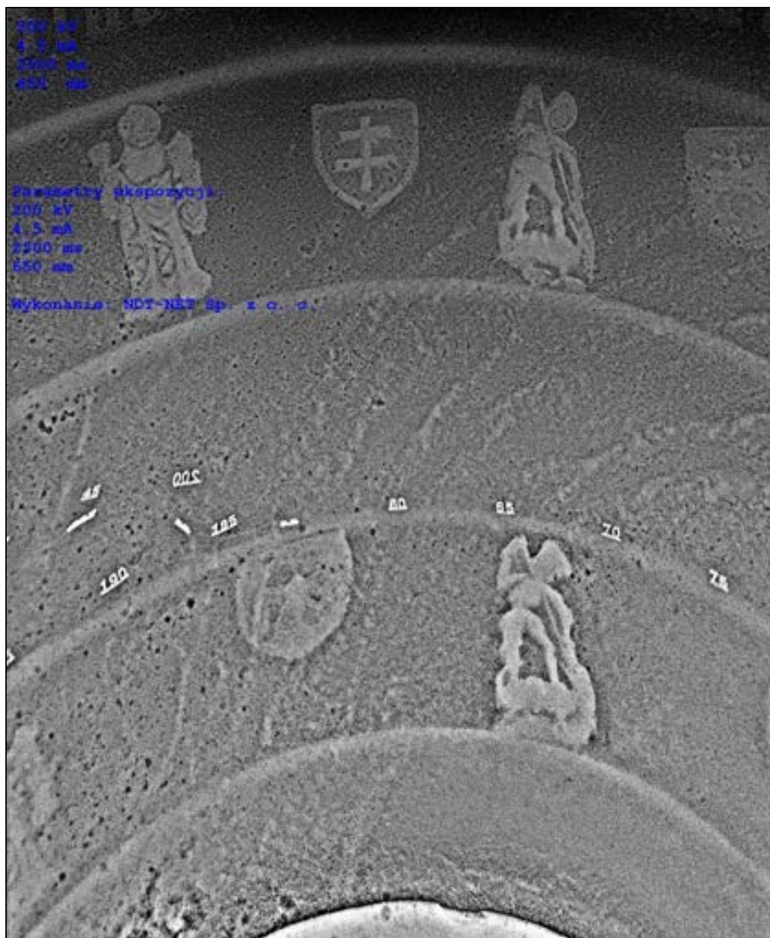
Rys. 8.68. Zdjęcie rtg czaszy chrzcielnicy z kościoła św. Szczepana. Parametry ekspozycji: napięcie 200 kV, natężenie prądu 4,5 mA, czas 2500 ms
