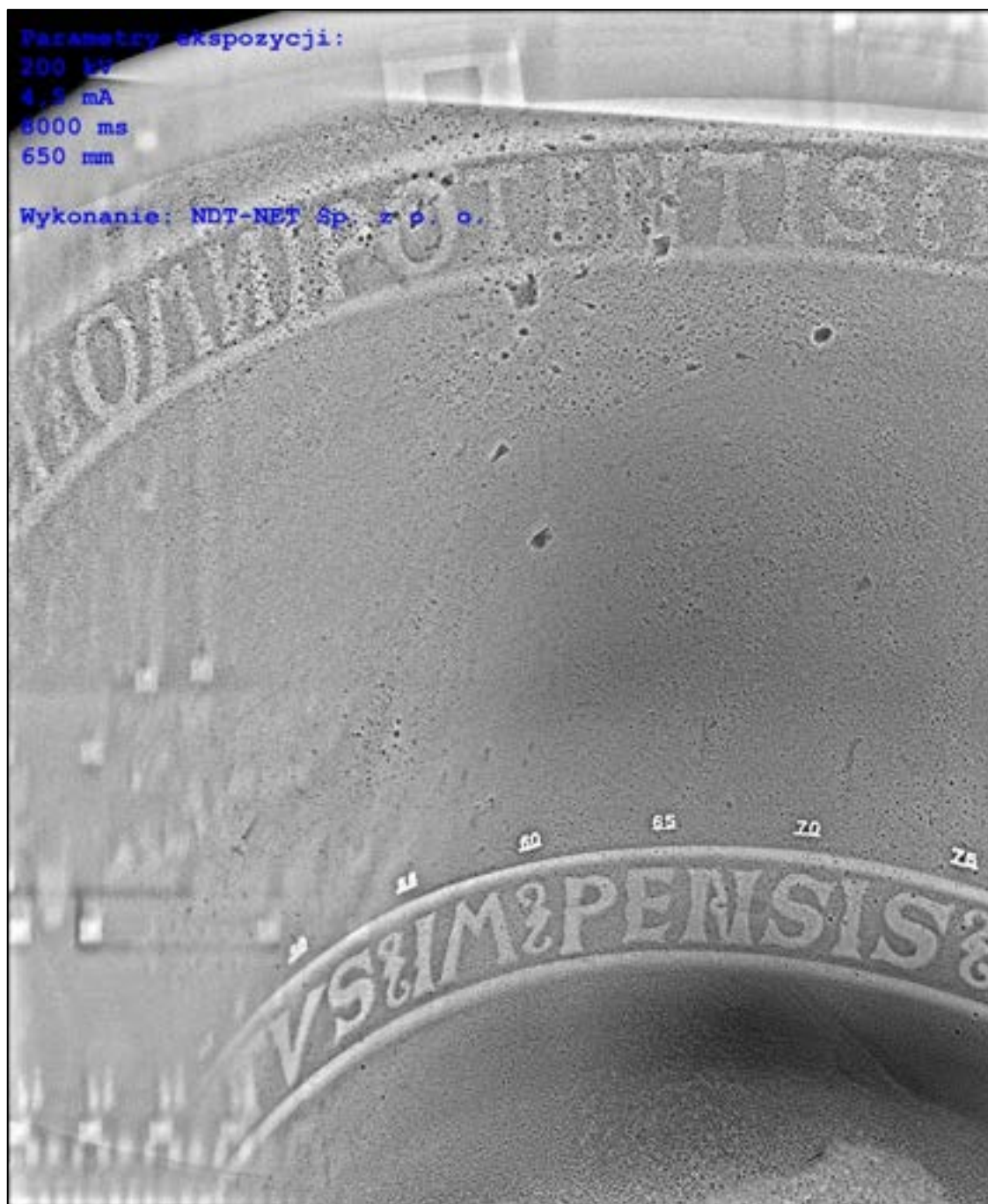
Rys. 8.90. Zdjęcie rtg czaszy chrzcielnicy z kościoła św. Mikołaja. Parametry ekspozycji: napięcie 200 kV, natężenie prądu 4,5 mA, czas 8000 ms
