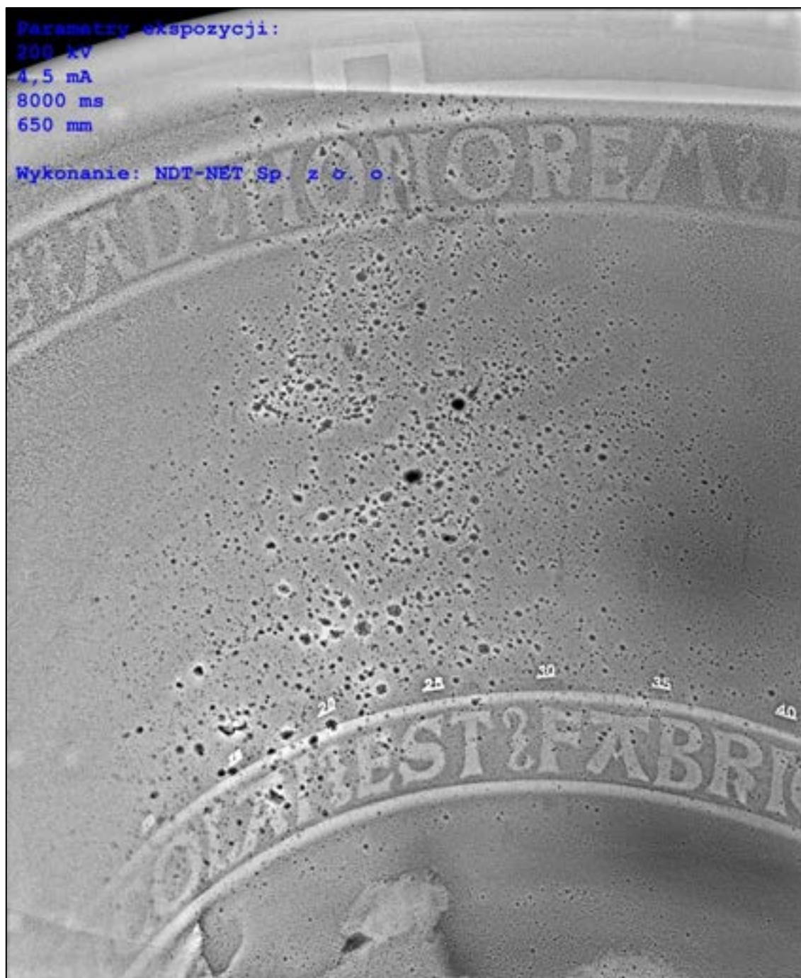
Rys. 8.92. Zdjęcie rtg czaszy chrzcielnicy z kościoła św. Mikołaja. Parametry ekspozycji: napięcie 200 kV, natężenie prądu 4,5 mA, czas 8000 ms
