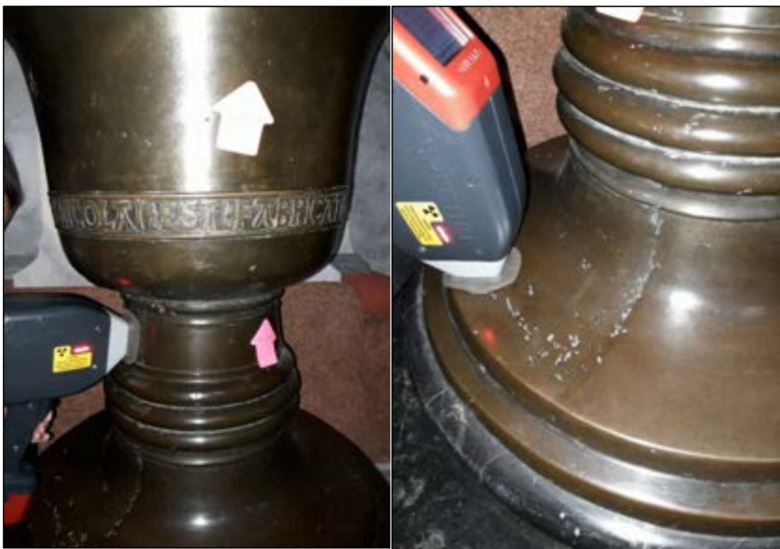
Rys. 8.1. Fotografie przedstawiające spektrometr fluorescencji rentgenowskiej z dyspersją energii SPECTRO xSORT w trakcie badań chrzcielnicy w kościele św. Mikołaja [fot. A. Mikołajska]
