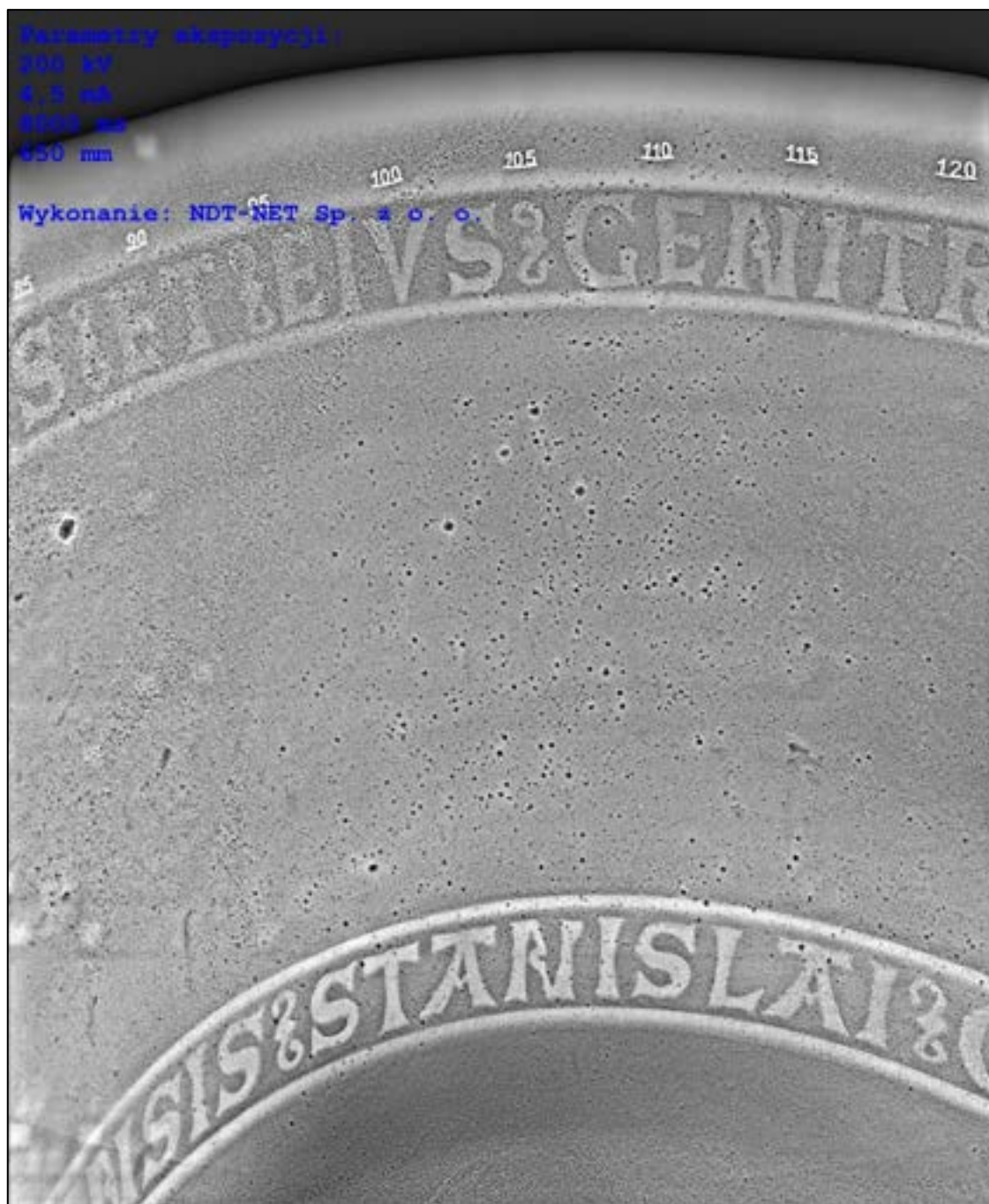
Rys. 8.87. Zdjęcie rtg czaszy chrzcielnicy z kościoła św. Mikołaja. Parametry ekspozycji: napięcie 200 kV, natężenie prądu 4,5 mA, czas 8000 ms
