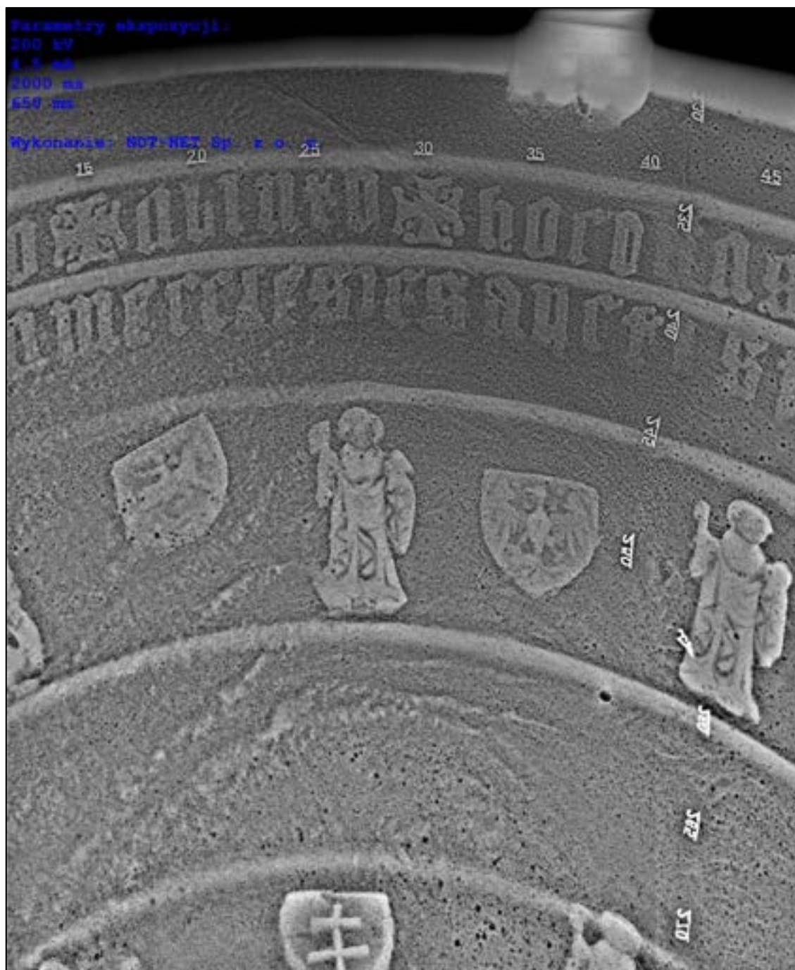
Rys. 8.73. Zdjęcie rtg czaszy chrzcielnicy z kościoła św. Szczepana. Parametry ekspozycji: napięcie 200 kV, natężenie prądu 4,5 mA, czas 2000 ms
