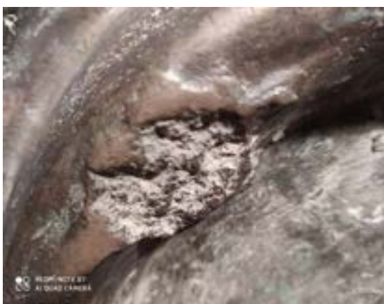
Rys. 8.59. Czasza chrzcielnicy w kościele św. Szczepana, ślad po układzie wlewowym [Fot. A. Garbacz-Klempka]
