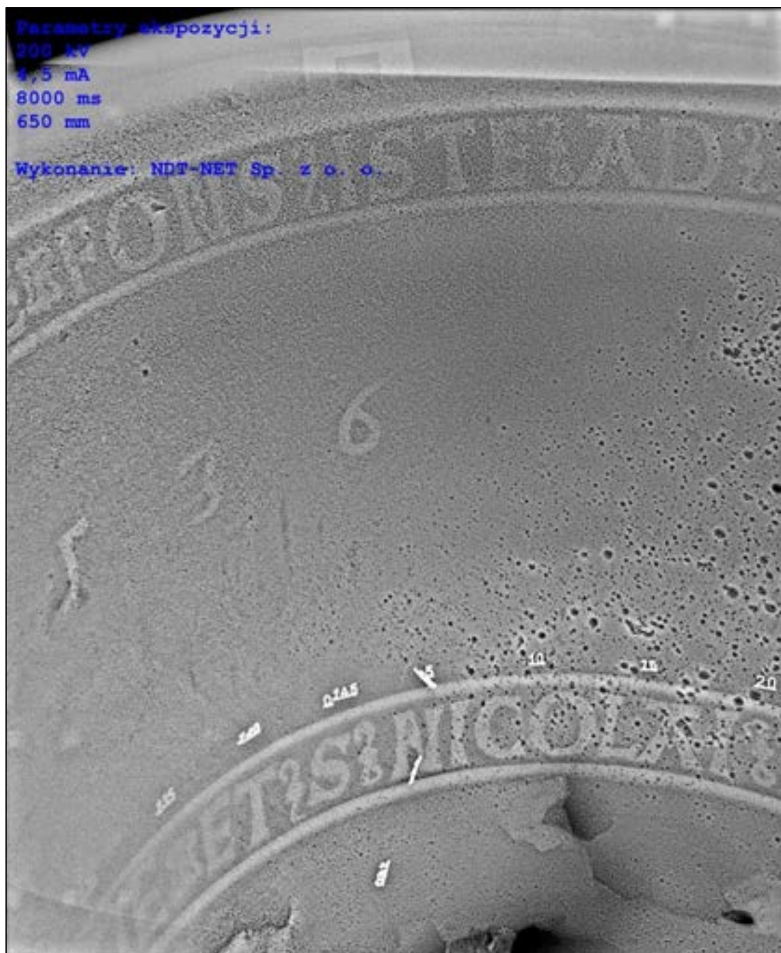
Rys. 8.93. Zdjęcie rtg czaszy chrzcielnicy z kościoła św. Mikołaja. Parametry ekspozycji: napięcie 200 kV, natężenie prądu 4,5 mA, czas 8000 ms
