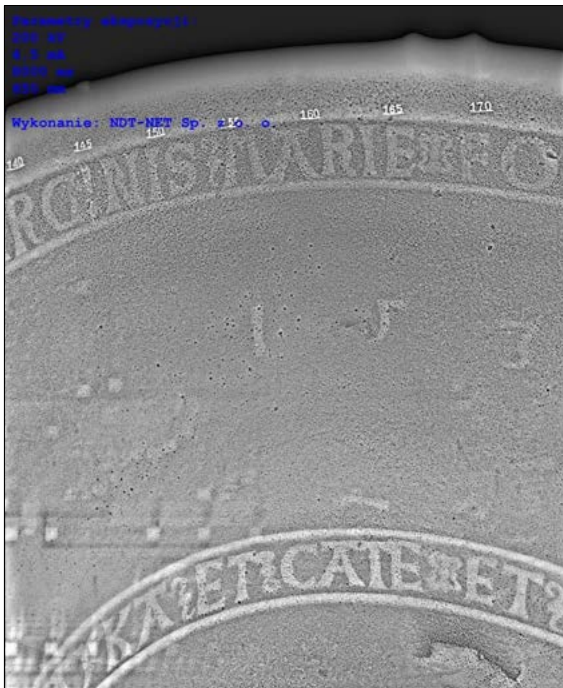
Rys. 8.85. Zdjęcie rtg czaszy chrzcielnicy z kościoła św. Mikołaja. Parametry ekspozycji: napięcie 200 kV, natężenie prądu 4,5 mA, czas 8000 ms
