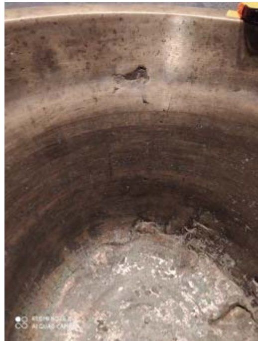
Rys. 8.79. Naprawy chrzcielnicy z kościoła św. Mikołaja wewnątrz czaszy [Fot. A. Garbacz-Klempka]
