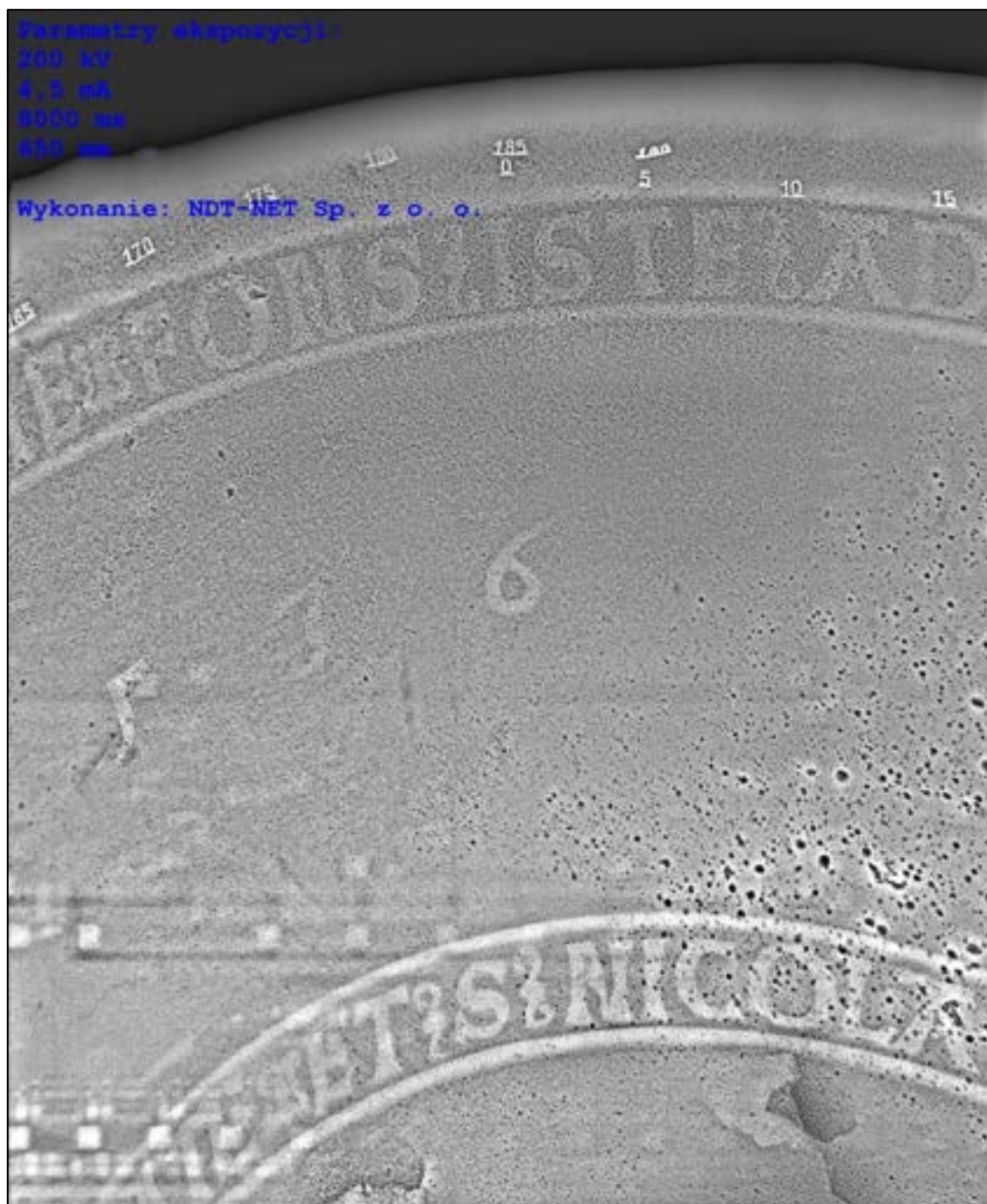
Rys. 8.84. Zdjęcie rtg czaszy chrzcielnicy z kościoła św. Mikołaja. Parametry ekspozycji: napięcie 200 kV, natężenie prądu 4,5 mA, czas 8000 ms
