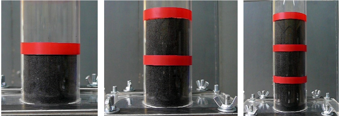
Rys. 56. Formy z PMMA wypełnione masą formierską
