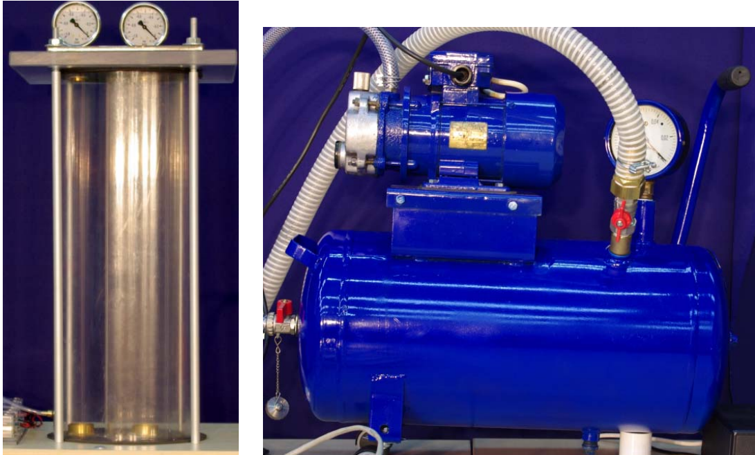
Rys. 52. Zbiorniki podciśnieniowe używane podczas badań.
