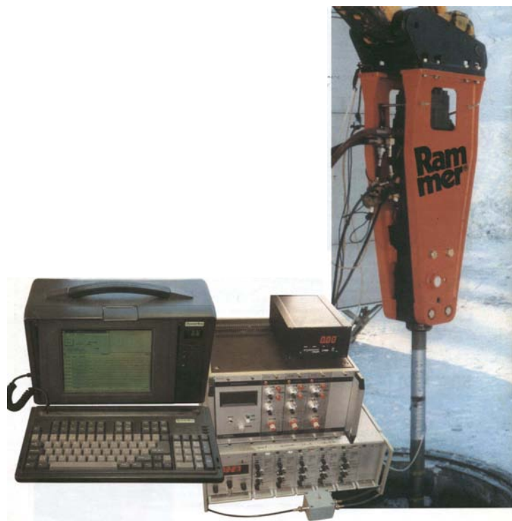
Rys. 4.6. Widok stanowiska pomiarowego młotów hydraulicznych firmy Rammer zrealizowanego wg metody CIMA/MBMB [22.]
