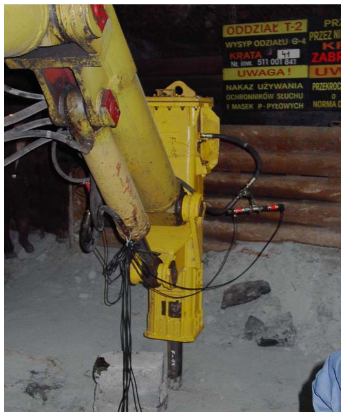
Rys. 9.6. Widok młota Roxon 602 o oznaczeniu F15, przygotowanego do badań
