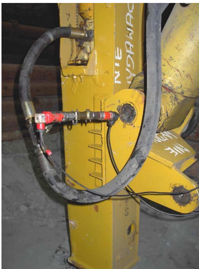
Rys. 9.3. Widok przygotowanego do badań młota Rammer S52 o oznaczeniu R59, zamocowanego na wysięgniku stacjonarnym, z zamontowanymi przetwornikami ciśnienia
