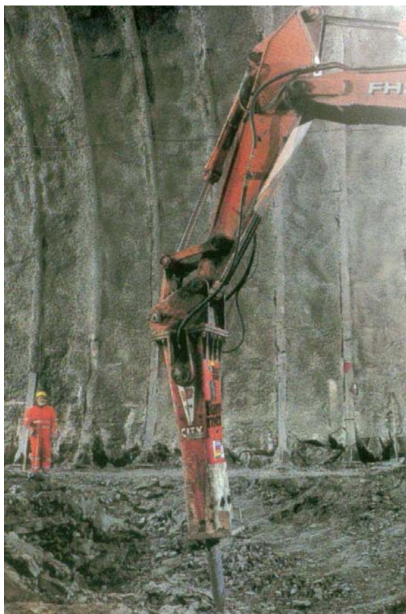
Rys. 2.15. Zastosowanie młota hydraulicznego zamocowanego na wysięgniku zainstalowanym na oponowym wozie samojezdnym do urabiania spągu wyrobiska [22]
