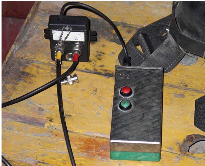
Rys. 9.5. Widok przenośnego rejestratora pomiarowego M2W3 wraz z przystawką Skorpion, przygotowanych do rejestracji mierzonych sygnałów
