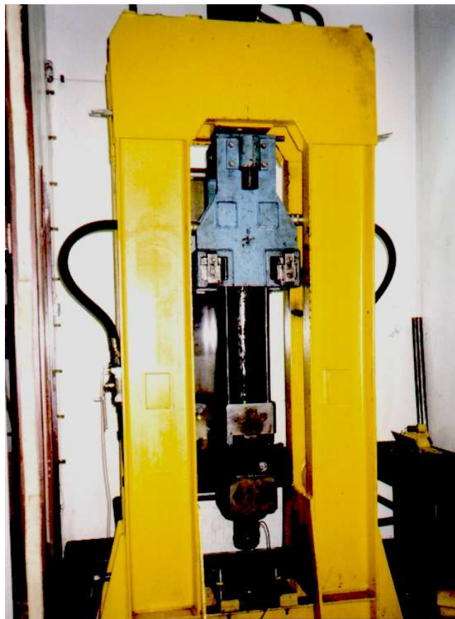
Rys. 9.7. Widok młota Roxon 602 o oznaczeniu F54, przygotowanego do badań na stanowisku badawczym
