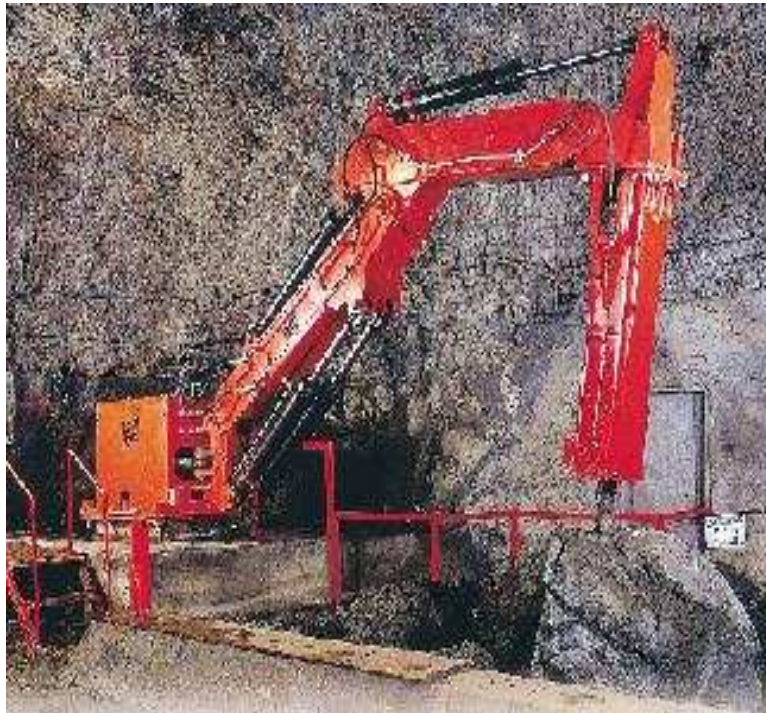
Rys. 2.16. Widok młota Rammer zamocowanego na wysięgniku stacjonarnym na kracie rozładowniczej
