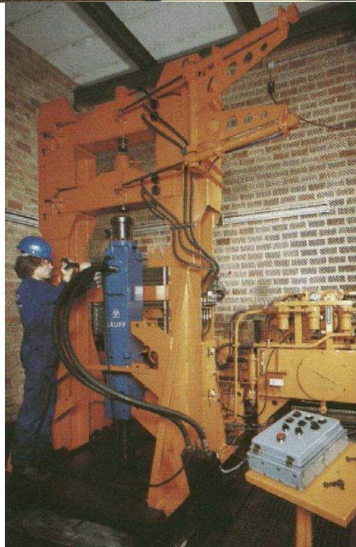
Rys. 4.5. Widok stanowiska do badania młotów hydraulicznych firmy Krupp Bautechnik: u góry - układ pomiarowo-sterujący, u dołu - młot na stanowisku [17]
