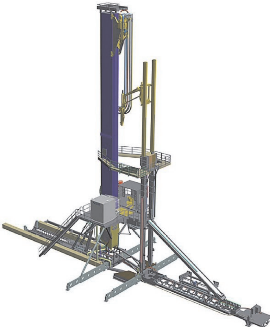
Rys. 6. Urządzenie do wiercen i rekonstrukcji odwiertów nowej generacji [4]
