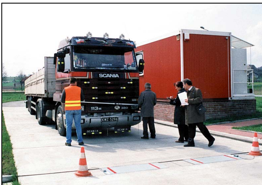
Rys. 2.6. Punkt kontrolny z systemem LS-WIM
