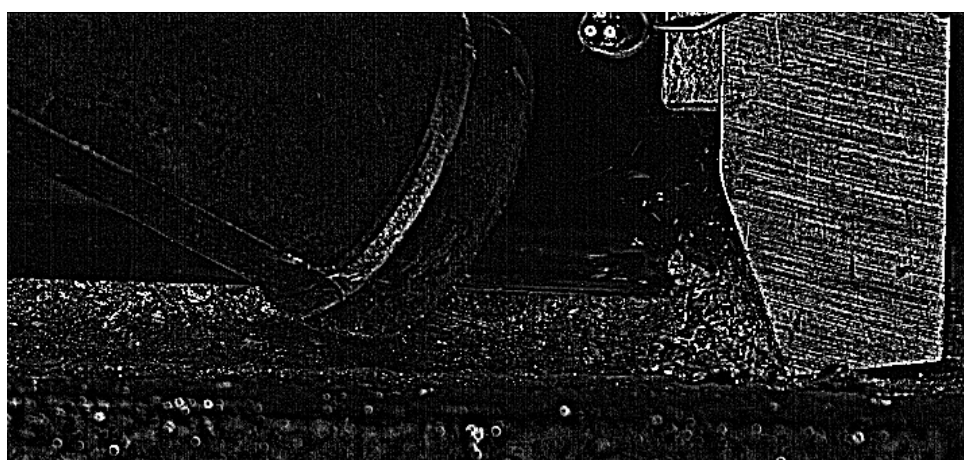
Rys. 4.24. Cyfrowy obraz mechanizmu odspajania materiału: a) oryginalny bez dodatkowej obróbki obrazu i b) z zastosowaną konturyzacją.
