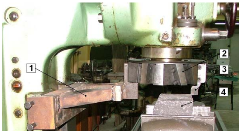
Rys. 4.10. Sposób blokowania ruchu obrotowego głowicy nożowej na frezarce: 1- jarko blokujące, 2 – głowica nożowa, 3 – narzędzie skrawające, 4 – próbka skrawanego tworzywa zamocowana w imadle maszynowym.
