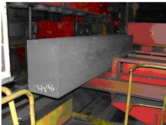
Rys. 4.5. Wygląd bloku węglowego WPW-65: a) przed obróbką, b) po obróbce.
