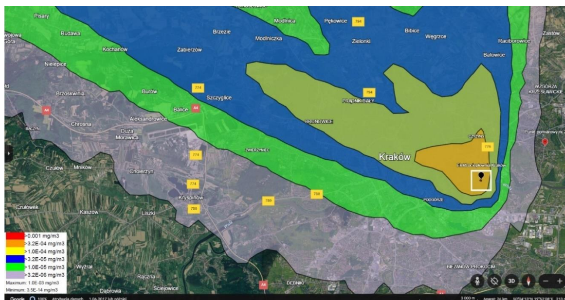
Rys. 65. Model HYSPLIT - koncentracja pyłów PM 2,5 wyemitowanych z Elektrociepłowni Kraków w powiększeniu z zaznaczonym punktem pomiarowym
