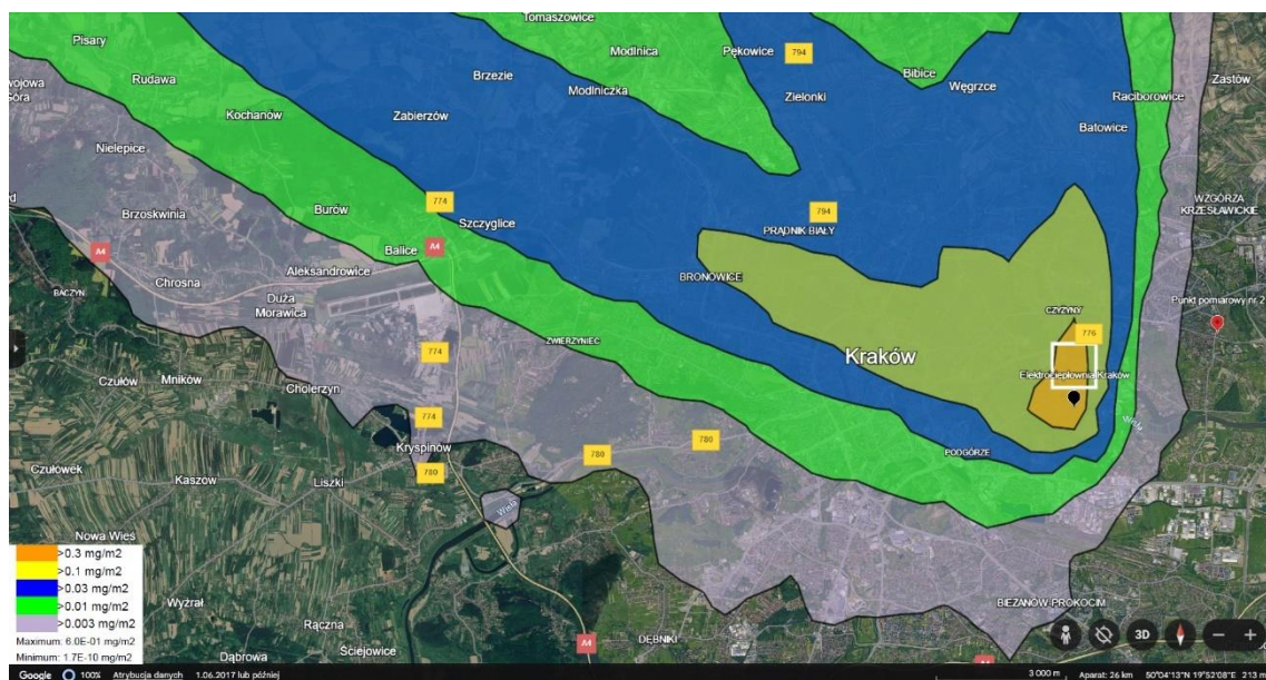
Rys. 67. Model HYSPLIT - depozycja pyłów PM 2,5 wyemitowanych z Elektrociepłowni Kraków w powiększeniu z zaznaczonym punktem pomiarowym
