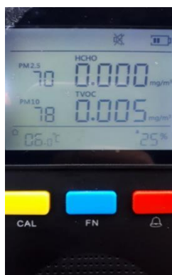
Rys. 15. Pyłomierz automatyczny, model WP6130 Źródło: własne
