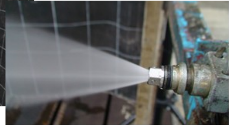
Struga wodna dyszy STK-HI, obrazująca ciągłość i kształt stożkowy strumienia
