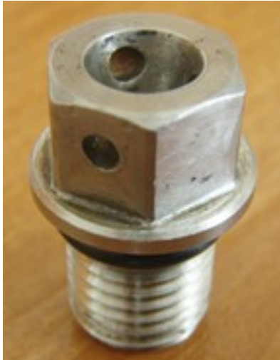
Dysza wodna z dodatkowym zasysaniem powietrza STK-HI
