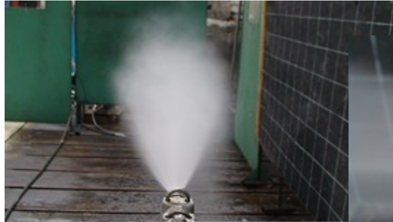
Struga wodna dyszy STK-HI, obrazująca ciągłość i kształt stożkowy strumienia
