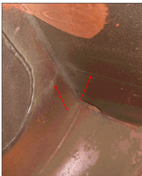
Rys. 6. Przykłady uszkodzeń elementów układu napędu i napędu koła czepakowego:
