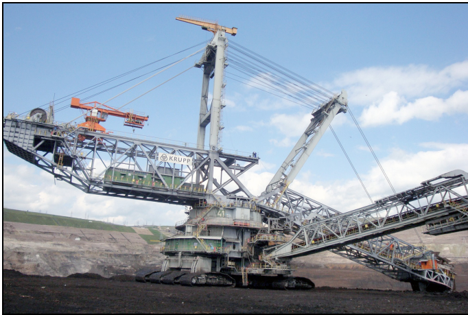
Rys. 4. Koparka SchRs 4600.50 podczas urabiania węgla
