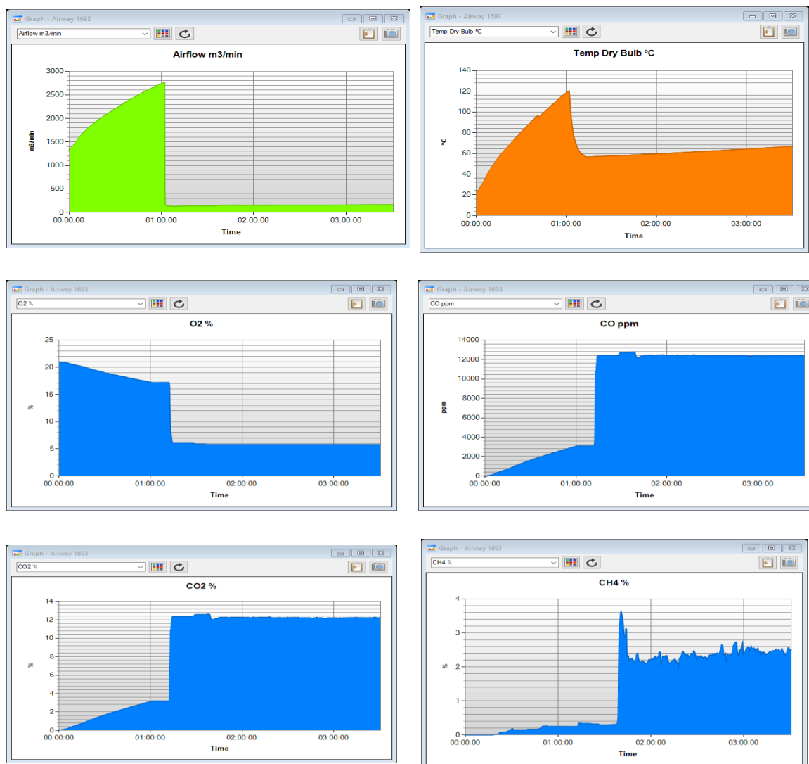
Rys. 168 Wyniki symulacji zmiany ilości, składu i temperatury powietrza na wylocie z rejonu wentylacyjnego (K-3) - moment zamknięcia K-2, K-4, K-5 01:05:00 w symulacji.
