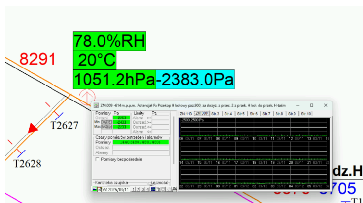
Rys. 79 Wycinek schematu w systemie Zefir z obliczonym automatycznym potencjałem – grupowy prąd powietrza „świeżego” (kolor niebieski) w Badaniu D
