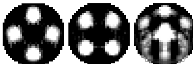
Rys. 4. Tomogramy uzyskane z fantomów symetrycznych
