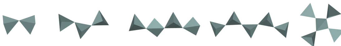
Rysunek 5. Aniony krzemotlenowe spotykane w oligokrzemianach niecyklicznych (na podstawie bazy danych ICSD i Mincrust)
