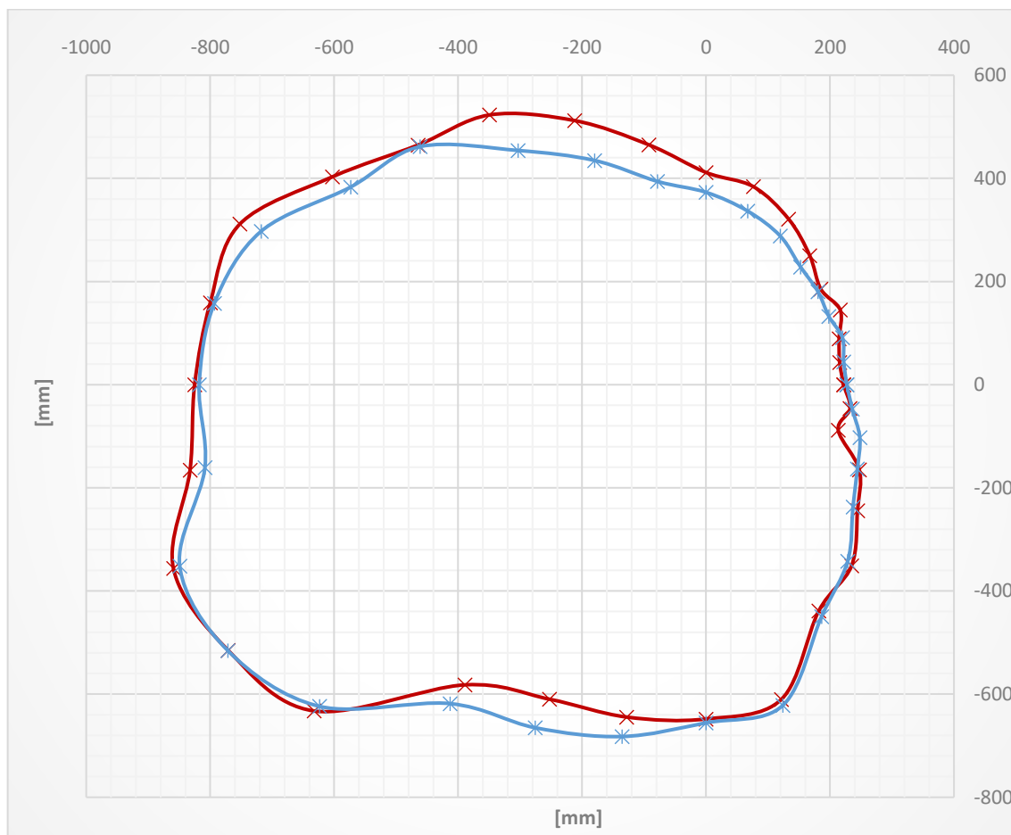
Rysunek 6.63 Kontur zbiornika wyznaczony na podstawie pomiaru bez obecności rury (linia niebieska) oraz w przypadku, kiedy głowica pomiarowa znajduje się wewnątrz nominalnej rury stalowej o średnicy 127 mm i grubości 5,5 mm (linia czerwona). Częstotliwość sygnału nadawczego odpowiadała pierwszej częstotliwości rezonansowej
