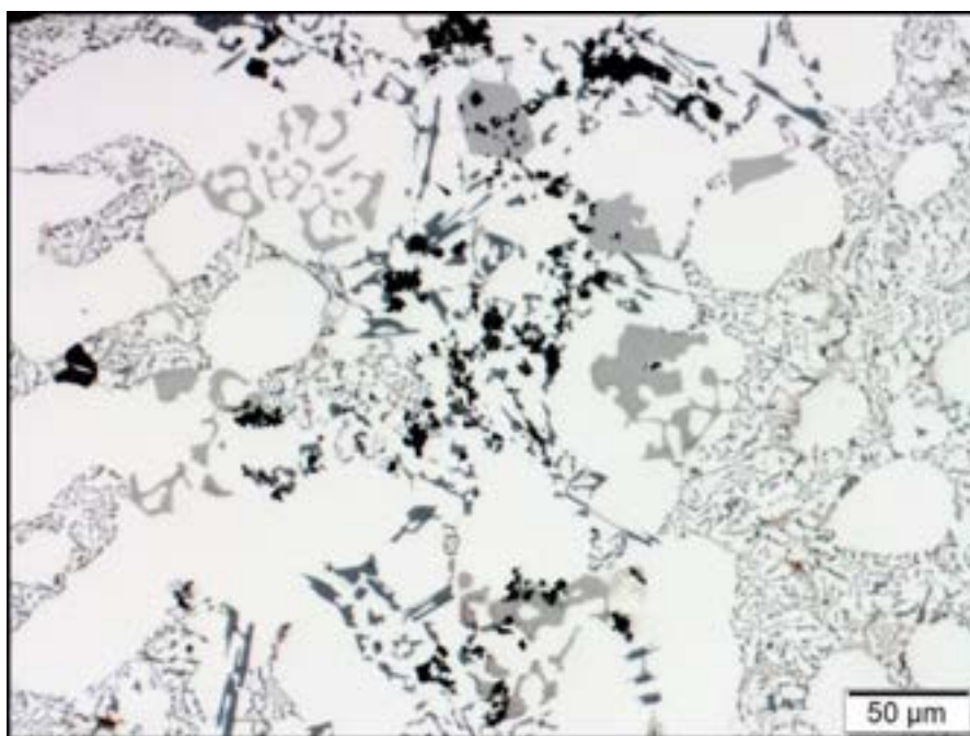
Rys. 4.69 Mikrostruktura wlewka wykonanego ze stopu AlSi9Cu3; czas rafinacji: 9 min, zawartość złomu obiegowego: 70%
