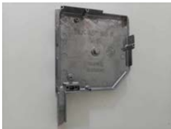
Rys. 3.3 Pokrywa kasety do systemu rolet wytworzona w procesie odlewania ciśnieniowego stopu AlSi9Cu3
