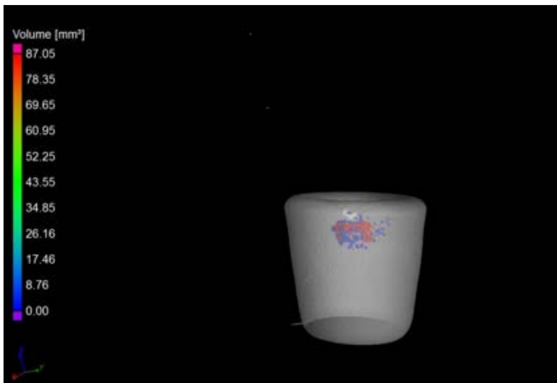
Rys. 4. 116 Wlewek ze stopu AlSi9Cu3 po 9 min. rafinacji; 80% zawartości złomu obiegowego
