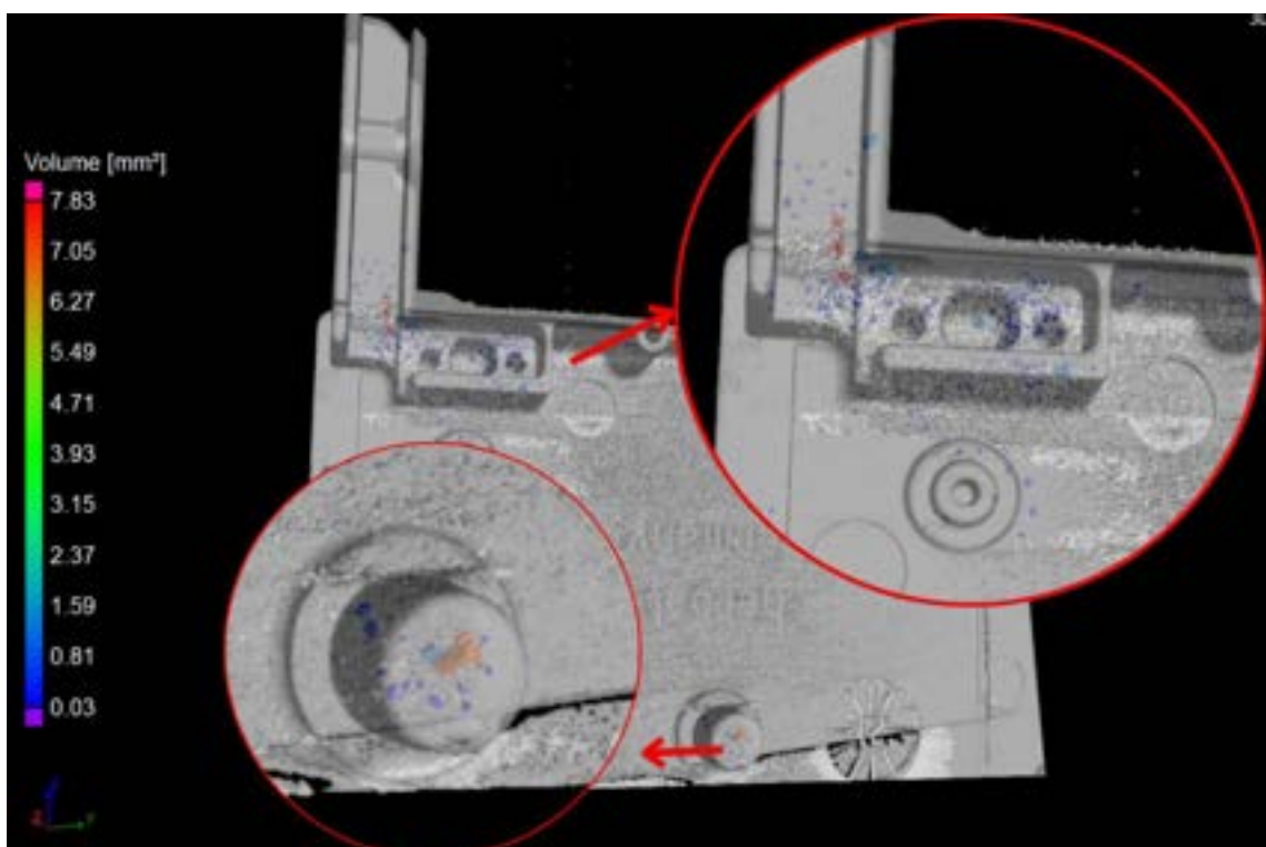
Rys. 4. 125 Odlew ze stopu AlSi9Cu3 po 9 min. rafinacji; 80% zawartości złomu obiegowego
