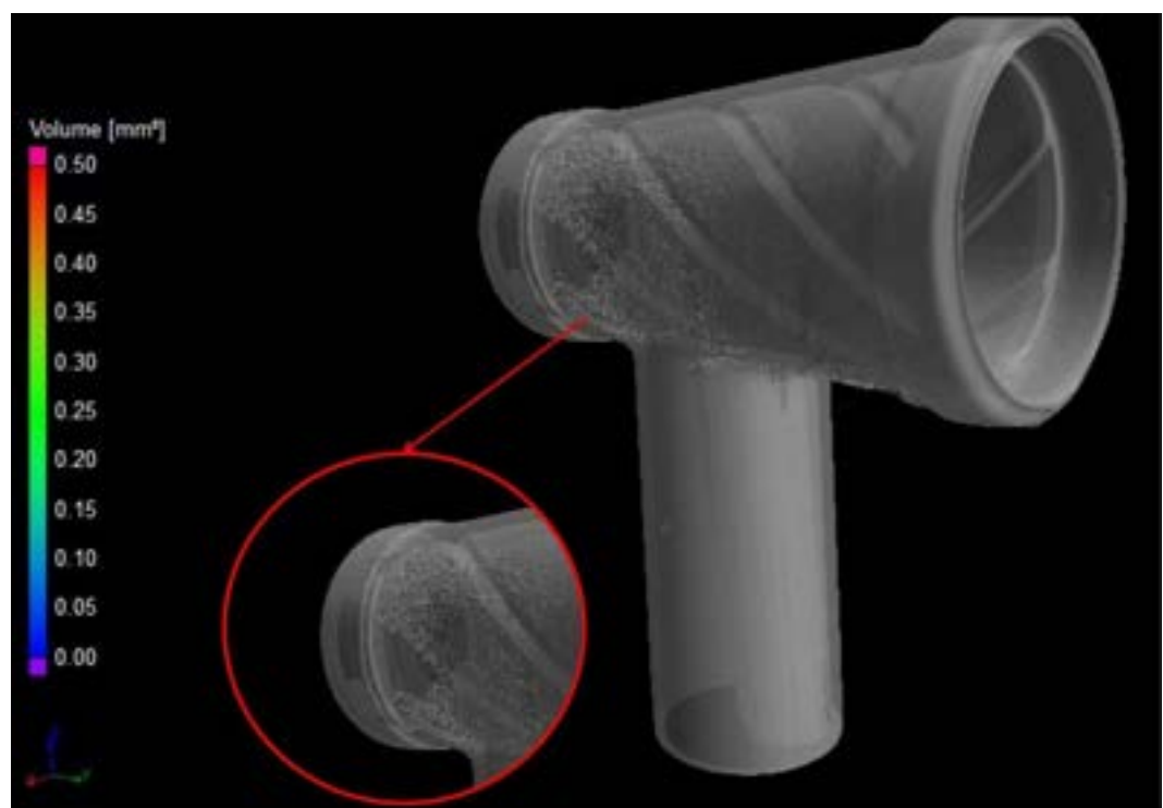
Rys. 4.53 Odlew ze stopu AlSi12 po 9 min. rafinacji; 60% zawartości złomu obiegowego
