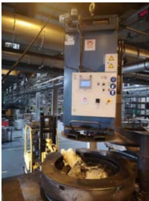
Rys. 3.1 Proces rafinacji barbotażowej
