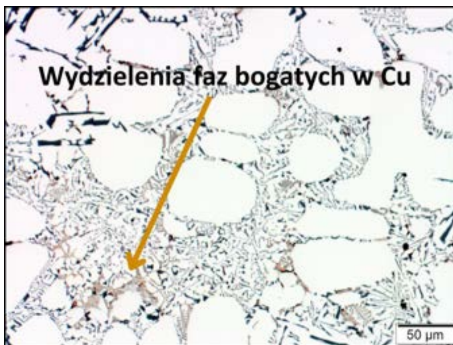
Rys. 4.65 Mikrostruktura wlewka wykonanego ze stopu AlSi9Cu3; czas rafinacji: 7 min, zawartość złomu obiegowego: 60%
