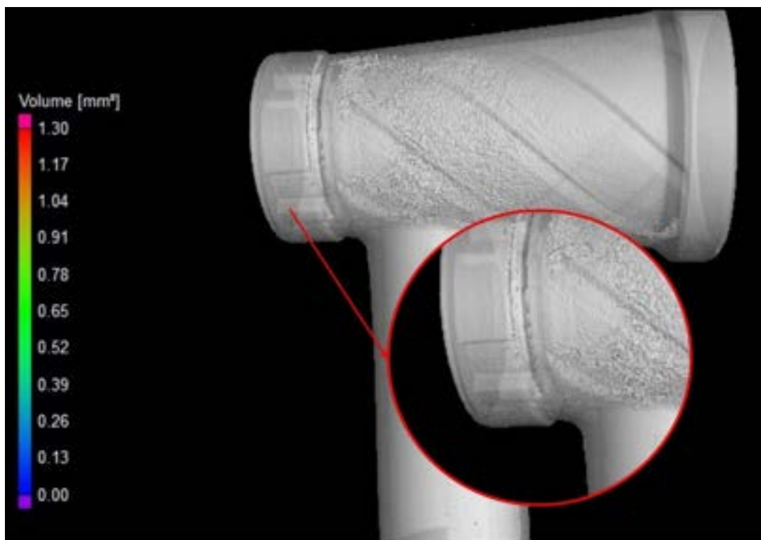
Rys. 4.56 Odlew ze stopu AlSi12 po 15 min. rafinacji; 60% zawartości złomu obiegowego
