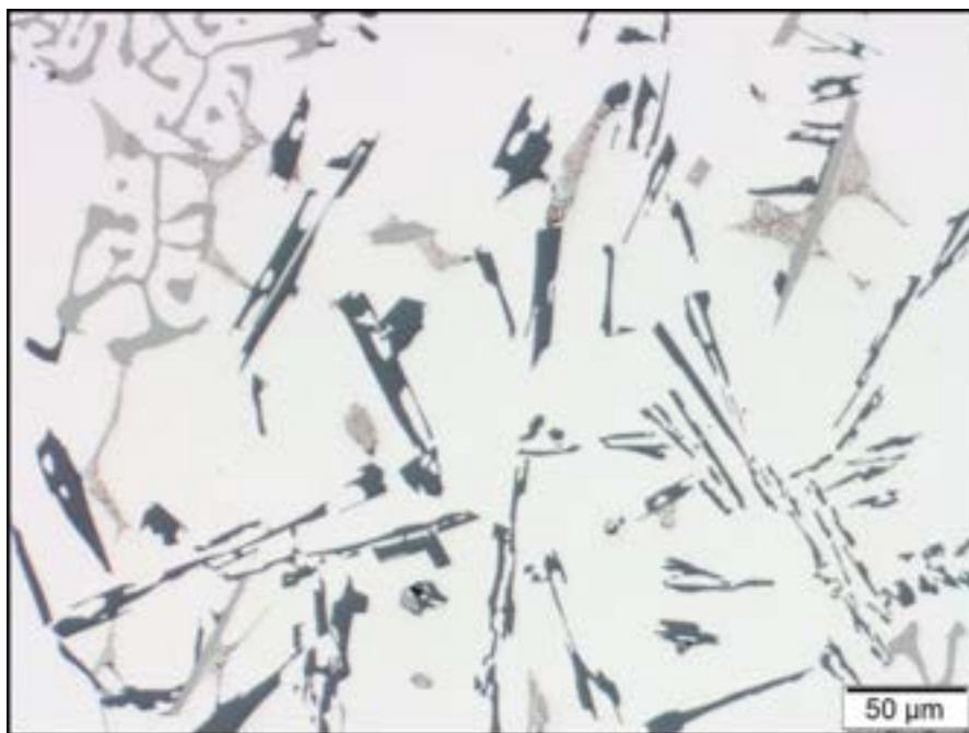
Rys. 4.68 Mikrostruktura wlewka wykonanego ze stopu AlSi9Cu3; czas rafinacji: 9 min, zawartość złomu obiegowego: 60%
