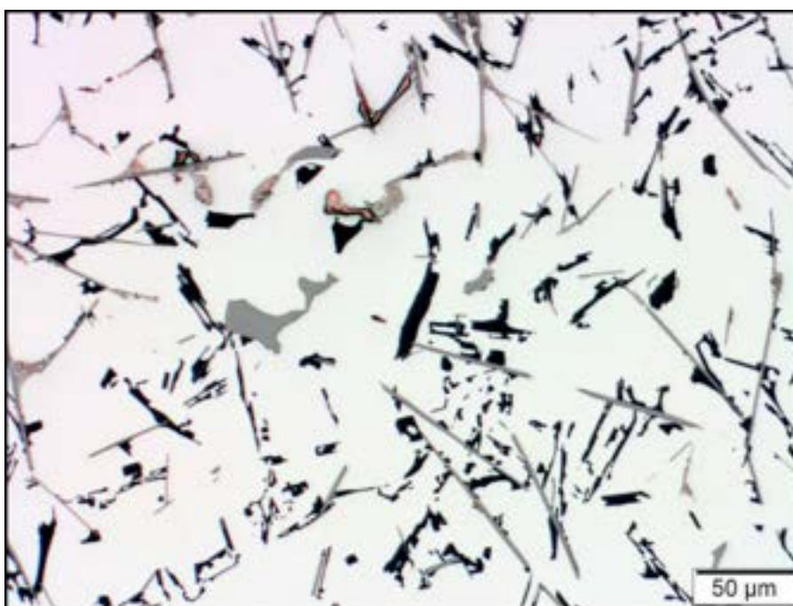
Rys. 4.73 Mikrostruktura wlewka wykonanego ze stopu AlSi9Cu3; czas rafinacji: 15 min, zawartość złomu obiegowego: 80%
