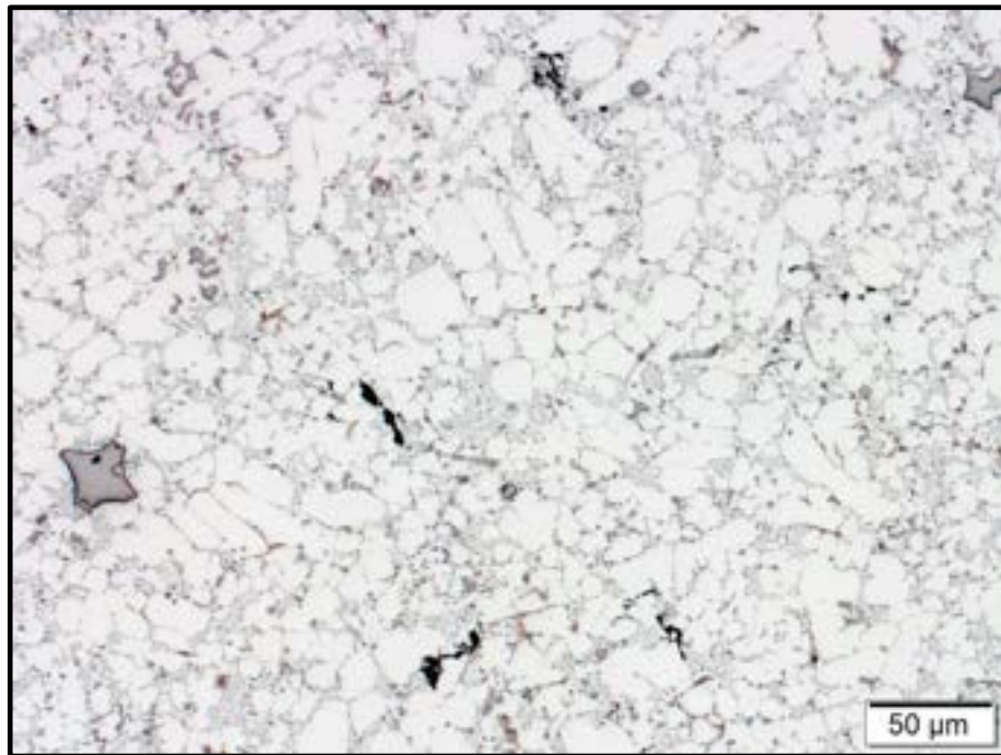
Rys. 4.76 Mikrostruktura odlewu ciśnieniowego wykonanego ze stopu AlSi9Cu3; czas rafinacji: 7 min, zawartość złomu obiegowego: 80%
