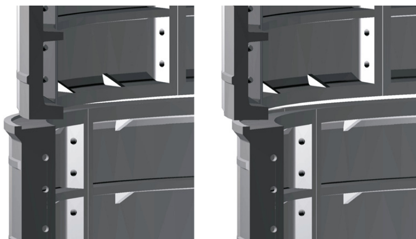
Rys. 8. Występujące przemieszczenie poziome pierścieni tubingowych w rejonie szczeliny pikotażowej
