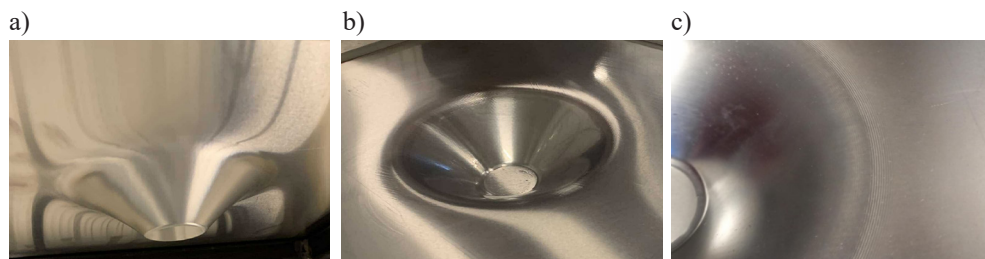
Rys. 8. Efekty tłoczenia prototypowej wylóczki: a) widok od spodu wylóczki; b) widok z góry; c) podgląd na ściankę
