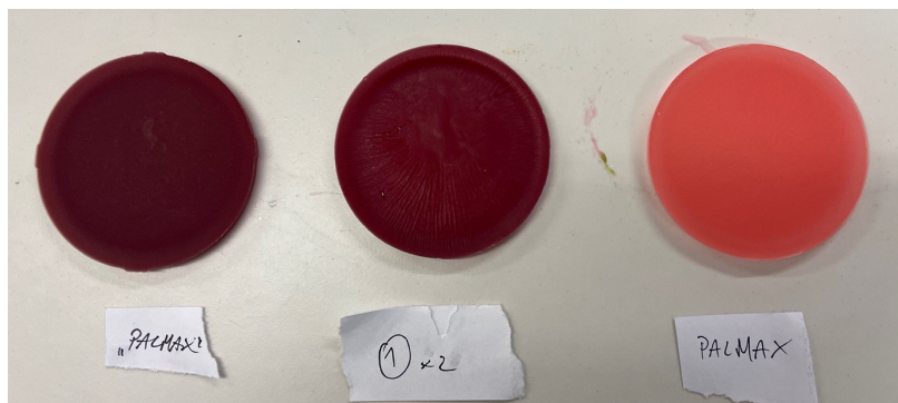
Rys. 5. Wyniki badania skuteczności ziemi „Palmax” komercyjnej i syntetycznej Od lewej do prawej: syntetyczna mieszanka ziemi „Palmax” otrzymana laboratoryjnie, podwójna dawka ziemi „Palmax” otrzymana syntetycznie, przemysłowa ziemia „Palmax” od producenta
