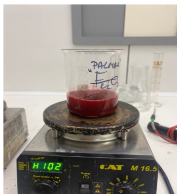
Rys. 4. Roztwór czerwonego barwnika z ziemią „Palmax” wykonaną laboratoryjnie
