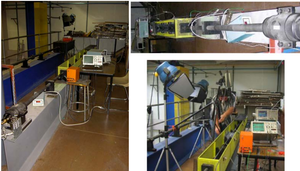
Rys. 3.16 Zmodyfikowany Pręt Hopkinsona (SHPB) na wyposażeniu Swinburne University of Technology.
