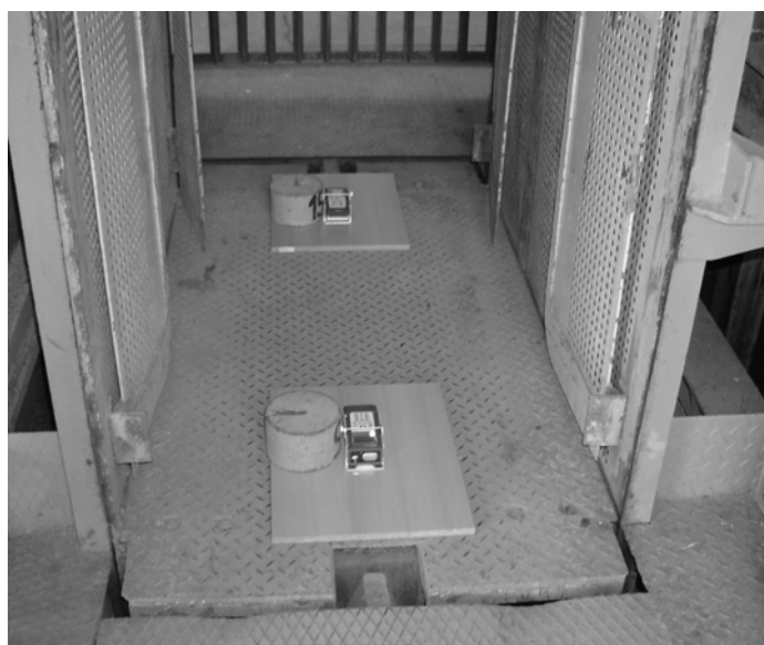
Rys. 2.19. Pomiary rozstawu czołowego przewodników w szybie Campi kopalni KS Bochnia za pomocą dalmierzy laserowych Disto plus
