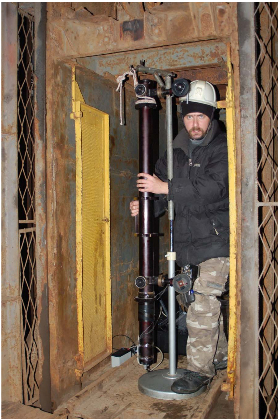
Rysunek 3.2. Inklinometr szybowy na przenośnym zawieszu ustawionym w klatce szybowej.
