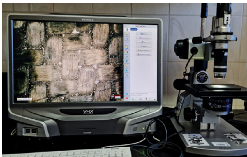
Struktura materiału CFRC 2D widoczna w mikroskopowym powiększeniu
