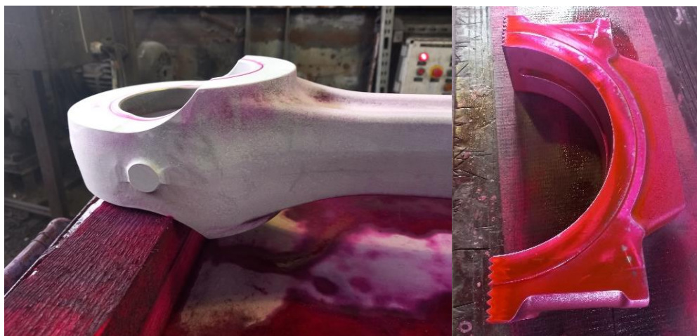
Rys. 58 Badanie penetracyjne korbowodów silnika SG 1 i SG4 (pokrycie półpanewek warstwą penetrantu i wywoływacza)
