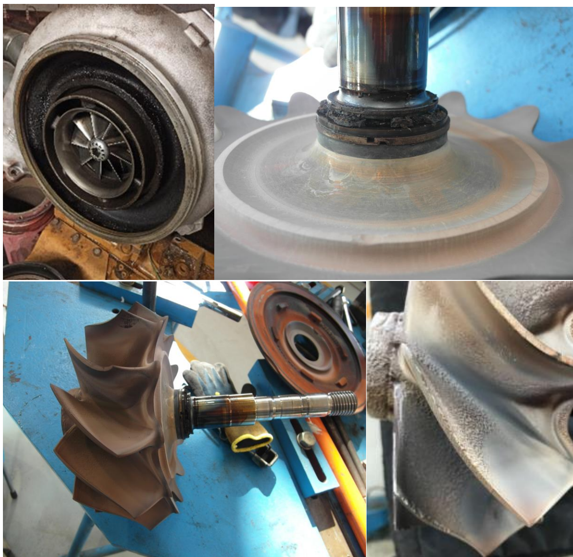
Rys. 88 Elementy szybkoobrotowe turbosprężarka SG1 silnik TCG (widoczne zanieczyszczenia)
