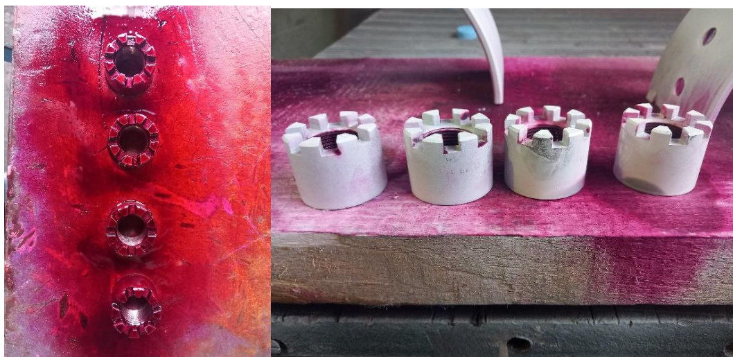
Rys. 59 Elementy złączne korbowodów silników SG1 i SG4 – nakrętki.
