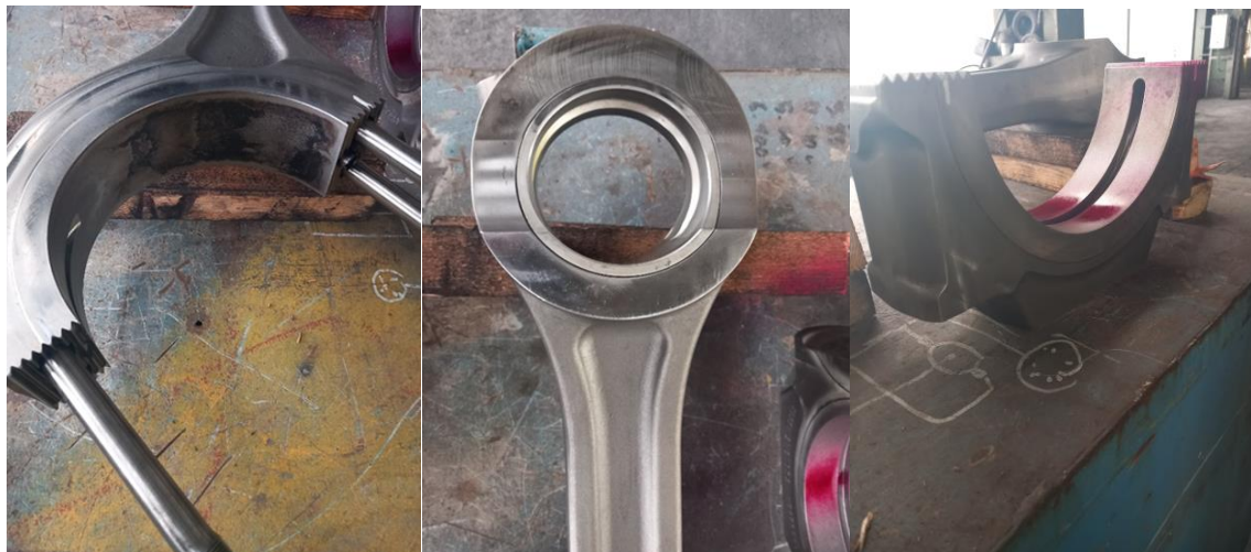
Rys. 54 Korbowód wraz ze śrubami, główka i stopa korbowodu silnika SG 1
