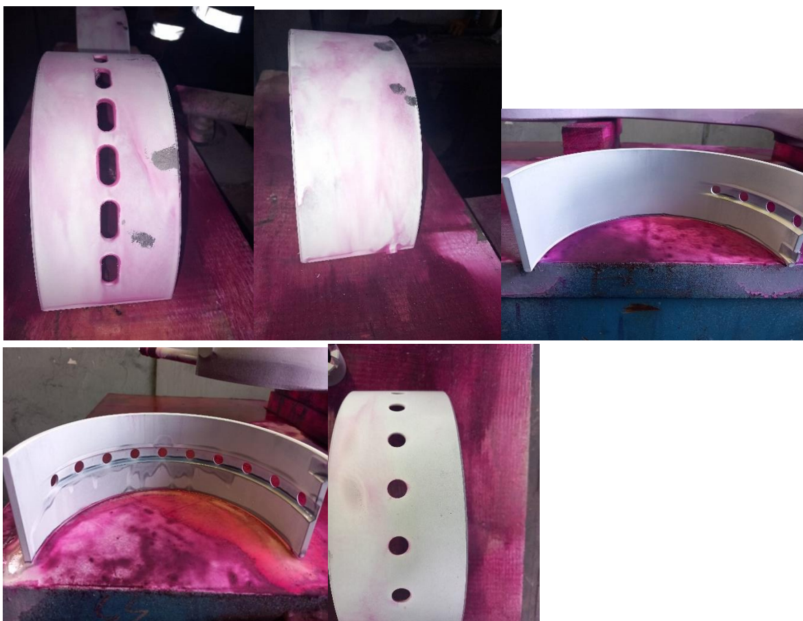
Rys. 56 Badanie penetracyjne półpanewki silnika SG 1 i SG4 (pokrycie półpanewek warstwą wywoływacza)
