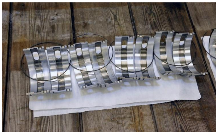
Rys. 19 Półpanewki silnika 2,0 MWe Silnik gazowy tłokowy CG170-20 Zakład Suszec
