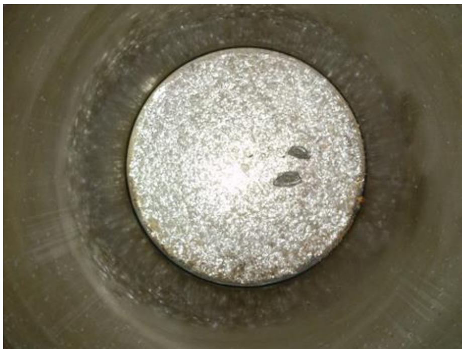
Rys. 16 Przykładowe uszkodzenie tłoka silnika.
