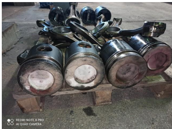
Rys. 52 Zdemontowane elementy silnika SG4
