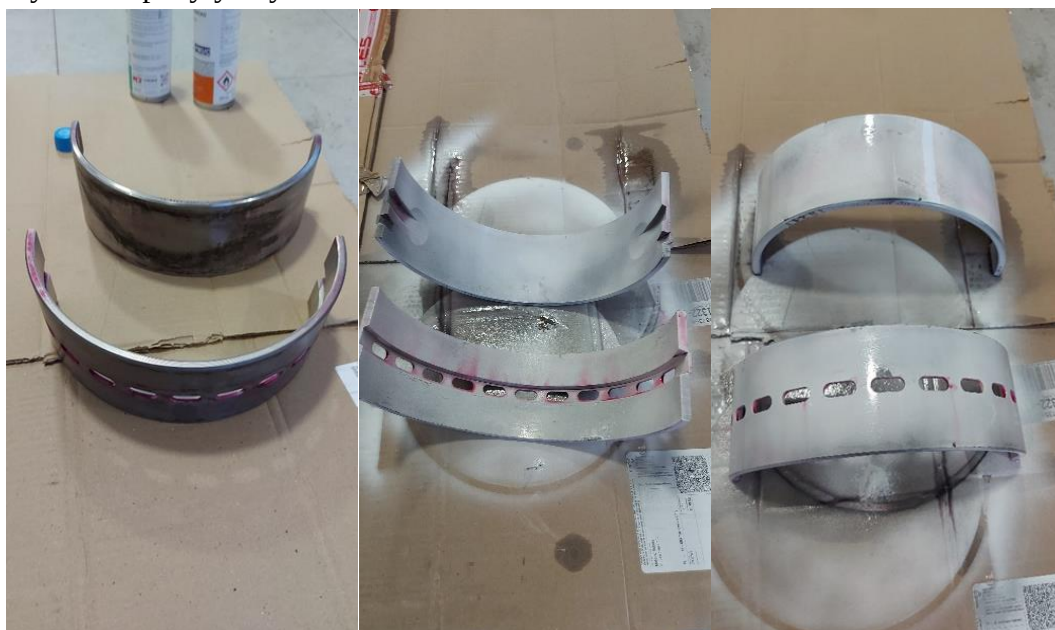
Rys. 57 Badanie magnetyczno-proszkowe (MT) półpanewki silnika SG 1 i SG4
