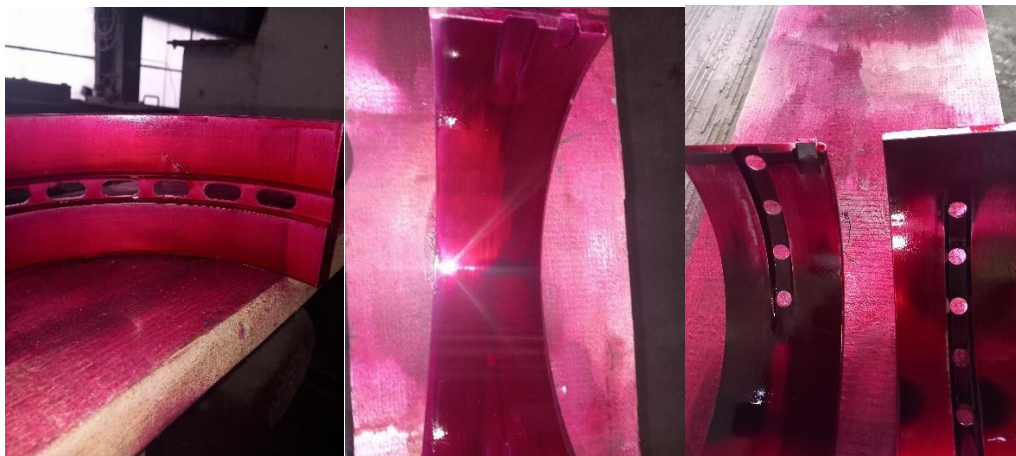
Rys. 55 Badanie penetracyjne półpanewek silnika SG1 i SG4 (pokrycie półpanewek warstwą penetrantu)
