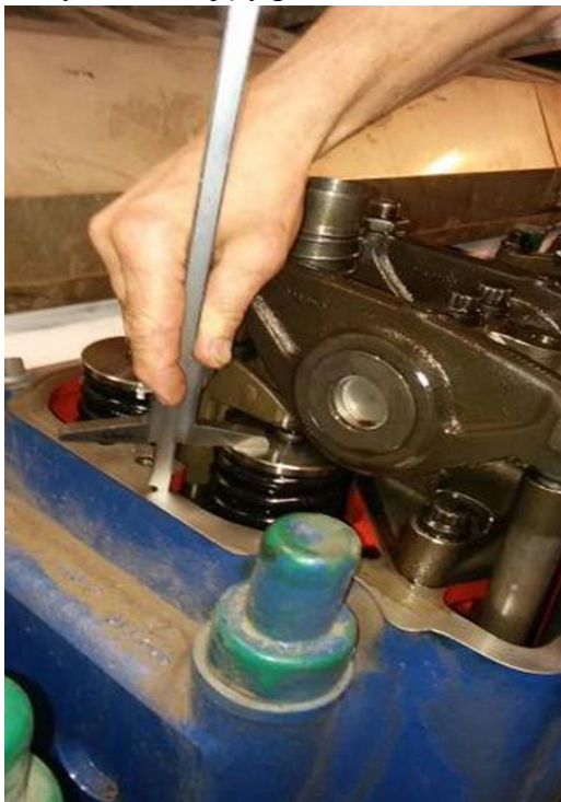
Rys. 12 Pomiar zbiecia trzonka zaworowego
