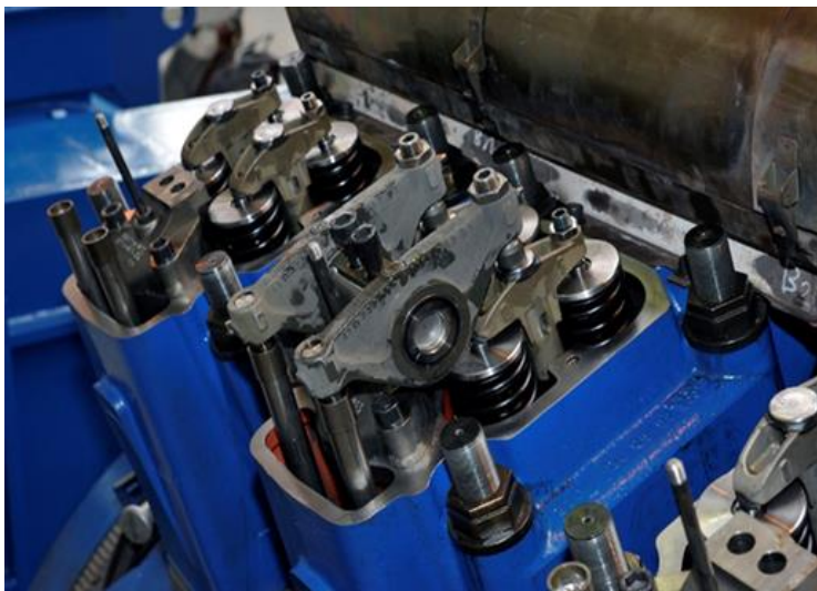
Rys. 11 Zdjęcie układu zaworowego cylindra silnika SG 1
