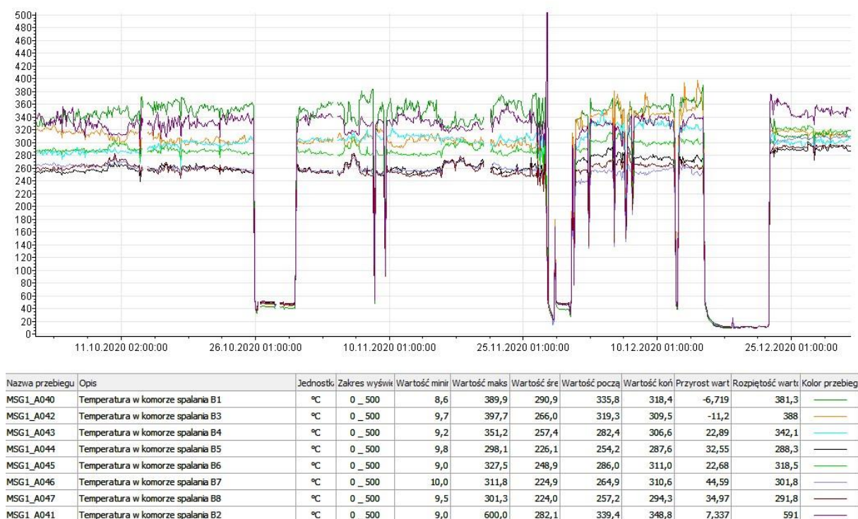
Rys. 68 Wykres temperatur w cylindrach B1 ÷ B8 silnika SG I w okresie 01.10.2020 – 31.12.2020
