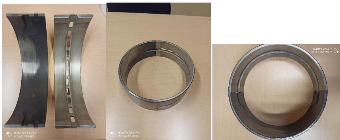
Rys. 53 Półpanewki silnika SG1 i SG4.
