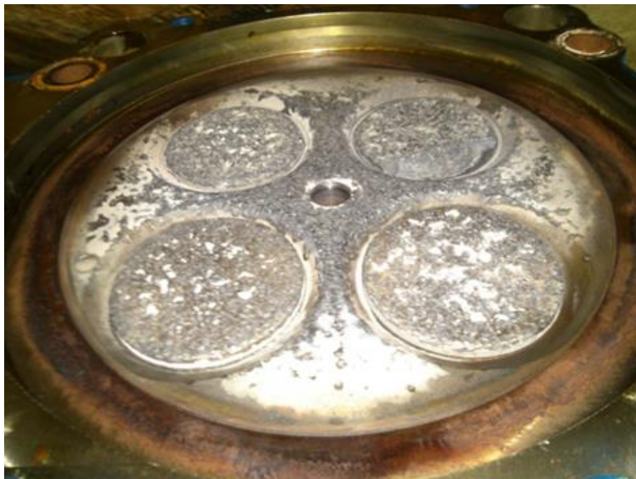
Rys. 15 Przykładowe uszkodzenie zaworów
