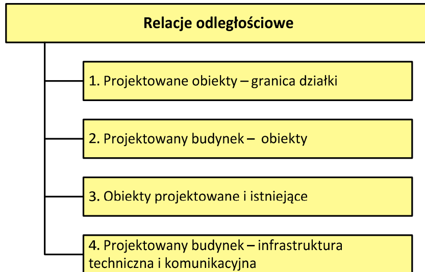
Rys. 2.12. Schemat przedstawiający podział relacji odległościowych w procesie weryfikacji dokumentacji projektowej
