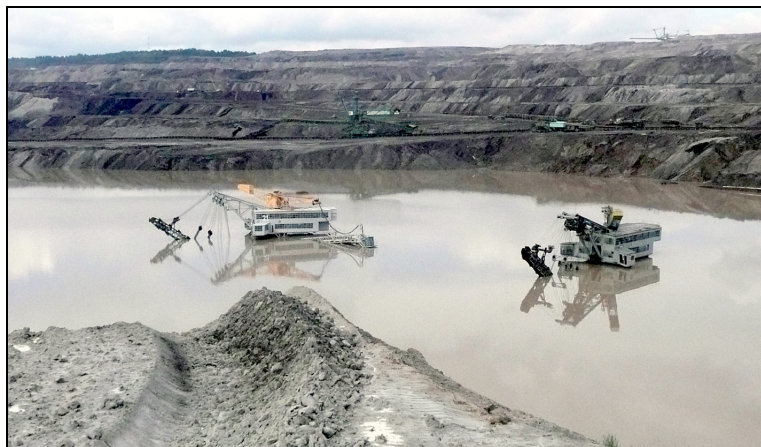
Rys. 7. Podtopione koparki łańcuchowe RS-560 (K-21 i K-30)
