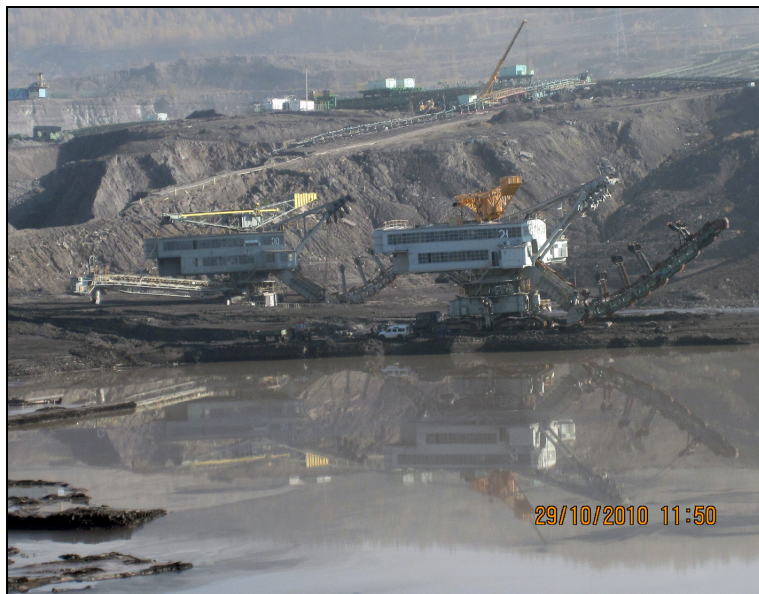
Rys. 8. Odzyskane koparki łańcuchowe RS-560 (K-21 i K-30)
