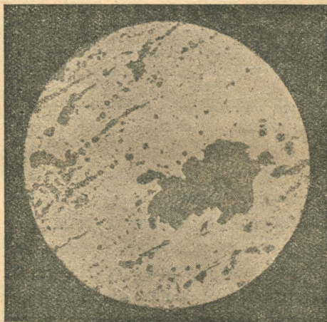
Rys. 45. Żelazo pudlarskie pod mikroskopem \times 250 .
