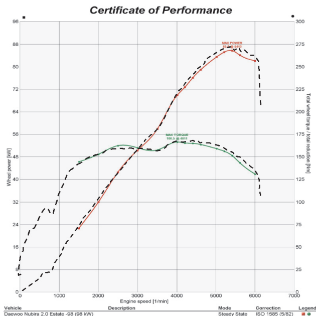
Rys. 18. Porównanie wyników otrzymanych w czasie testów prezentowanego systemu pomiarowego z wykresami otrzymanymi na hamowni [2]. Linie ciągłe – przebiegi otrzymane na hamowni, Linie przerywane – przebiegi otrzymane w wyniku testu
