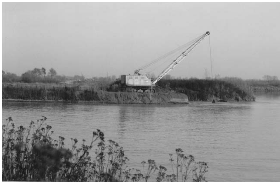
Fig. 4. Eksploatacja kruszywa naturalnego spod wody
