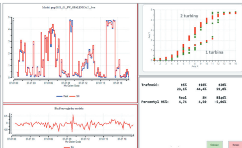
Rys. 12. Przykładowe okno aplikacji do prognozowania: a) elektrownia wiatrowa: model \text{moc} = f(\text{prędkość wiatru, liczba pracujących turbin, temperatura}) ; b) model uczony na podstawie zdyskretyzowanego zbioru uczącego
