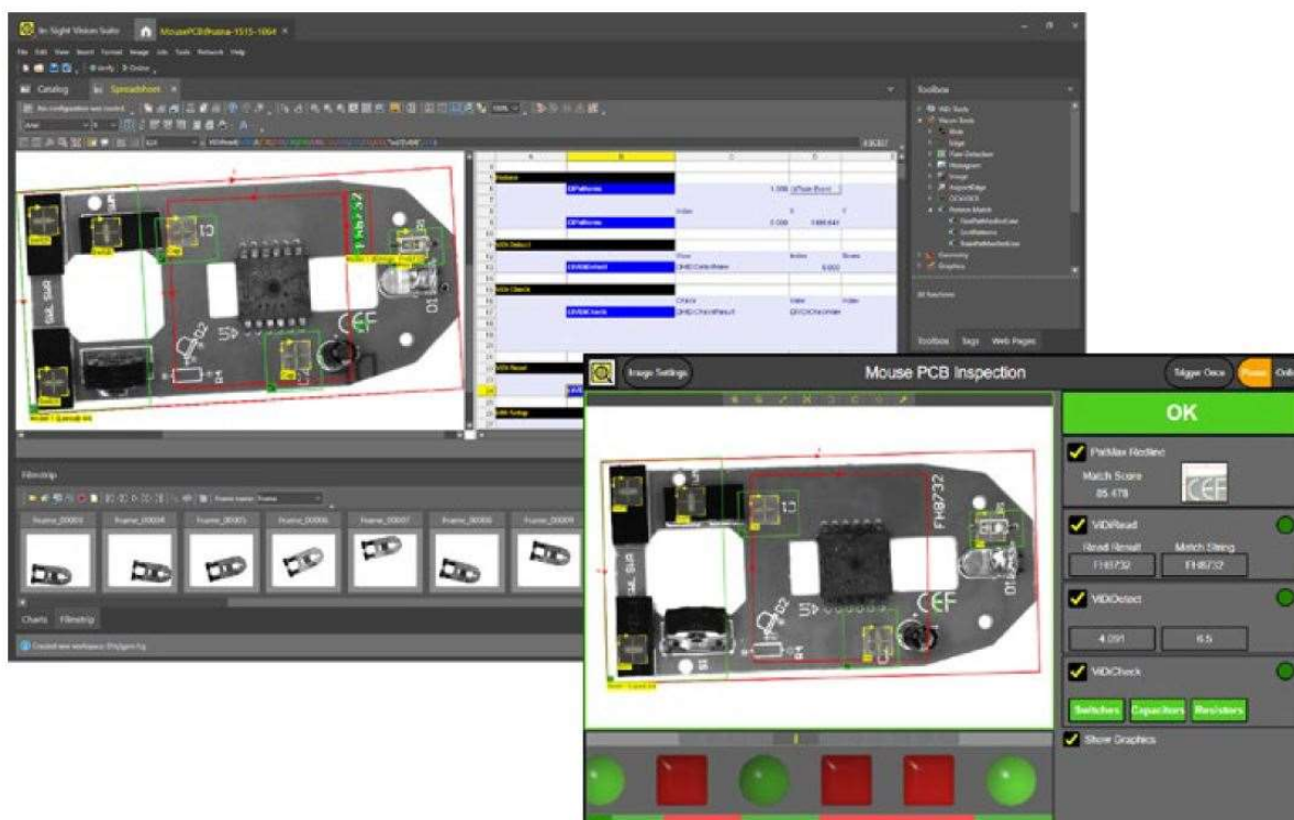
Rysunek 5.1.1 Detekcja wadliwej części przez system deep learning (niezalutowany układ scalony) [2]
