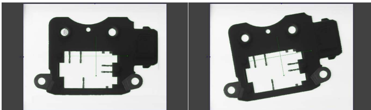
Rysunek 4.4.1 Wyznaczanie orientacji - widok detalu (wzorzec i badany element) [materiały własne]
