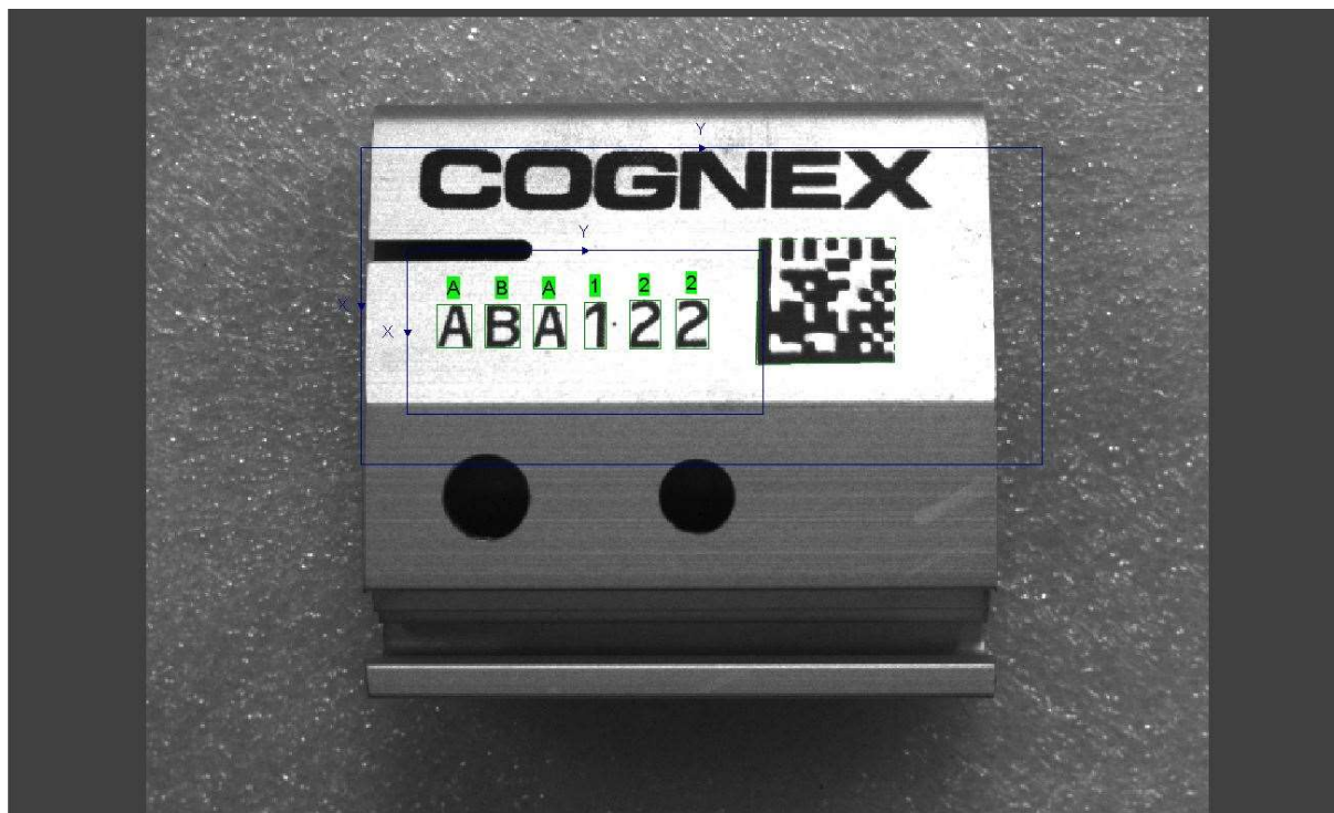
Rysunek 4.3.1 Odczyt znaków OCR i DataMatrix - widok detalu [materiały własne]
