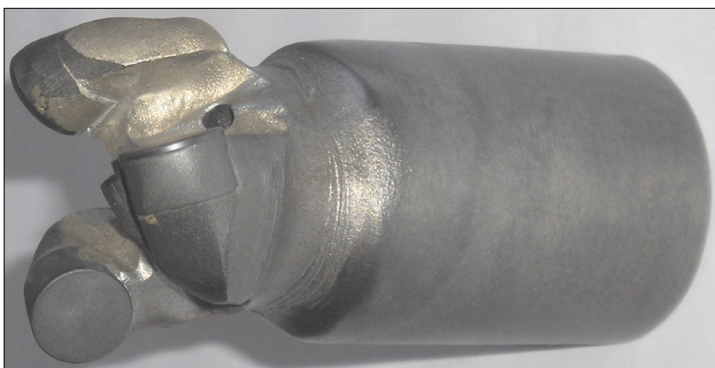
Rys. 1. Świder małosrednicowy PDC używany w wierceniach podziemnych
