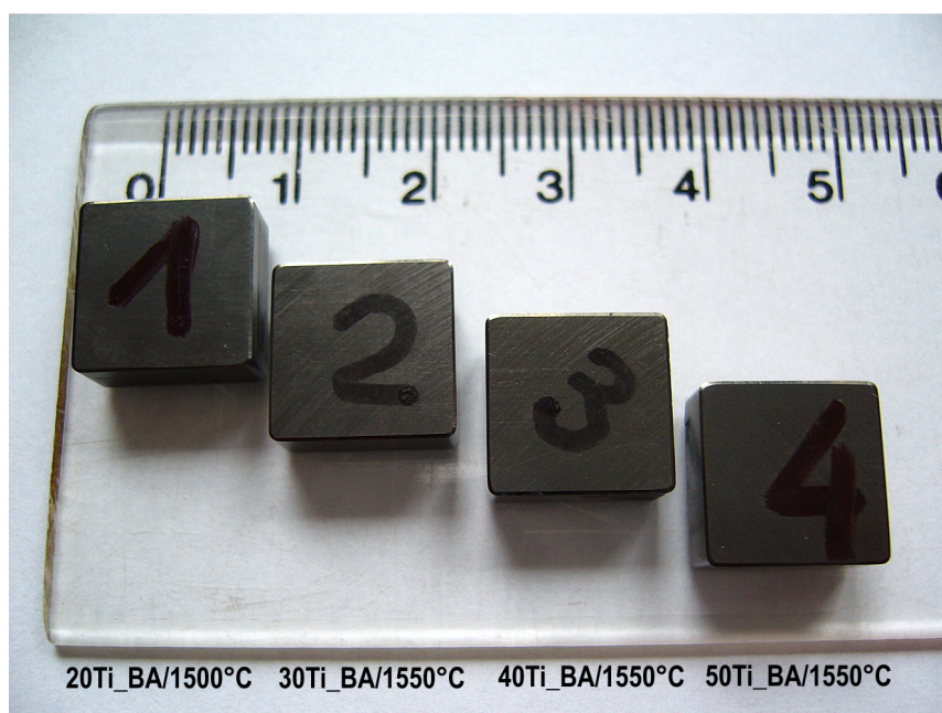
Rys. 10.1. Widok ogólny płytek wielostrzowych wykonanych z podanych kompozytów Y-ZrO 2 /TiB 2 . Widoczne są sfazowania umacniające krawędzie próbek.
