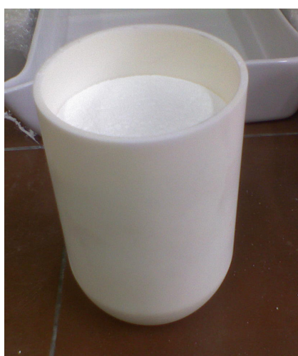
Rys. 6.3. a) Widok ogólny proszku 20Ti. Proszek znajduje się w alundowym tyglu, w którym wykonywano krystalizację prekursora żelowego metoda prażenia. b) Piec firmy Nabertherm użyty do prażenia żeli – prekursorów 20Ti-50Ti. Precyzja regulatora temperatury wynosiła \pm 1 °C.
