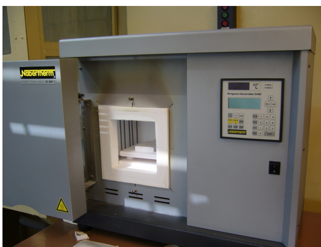
Rys. 6.3. a) Widok ogólny proszku 20Ti. Proszek znajduje się w alundowym tyglu, w którym wykonywano krystalizację prekursora żelowego metoda prażenia. b) Piec firmy Nabertherm użyty do prażenia żeli – prekursorów 20Ti-50Ti. Precyzja regulatora temperatury wynosiła \pm 1 °C.
