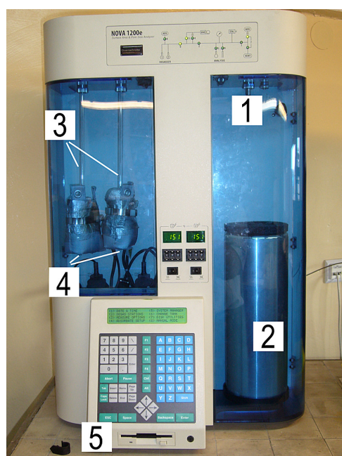
Rys. 7.3. Urządzenie NOVA 1200e firmy Quantachrome Instruments do ilościowej rejestracji adsorpcji par na ciele stałym: 1) port pomiarowy, 2) naczynie na czynnik ustalający izotermiczne warunki pomiaru – np. ciekły azot, 3) celki pomiarowe podłączone do portu próżniowego odgazowania próbek, 4) płaszcze grzejne, pozwalające na prowadzenie odgazowania w temperaturach 20-300 °C, 5) konsola sterująca.
