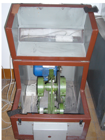
Rys. 6.18. a) Młyn obrotowo-wibracyjny konstrukcji J. Sidora (AGH), użyty w trakcie mielenia proszków kompozytowych na bazie mieszanin 2,5Yko i 2,5Yba; b) komora młyna z poliamidu wraz z mielnikami 3Y-TZP. Amplituda i częstotliwość drgań komory: 7 mm i 11 Hz.
