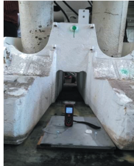
Rys. 5. Ręczny pomiar wysokości pracy obudowy zmechanizowanej
