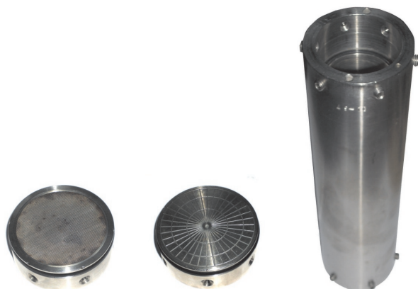
Rys. 9. Cella wysokociśnieniowa oraz dekle prasy HPHT
