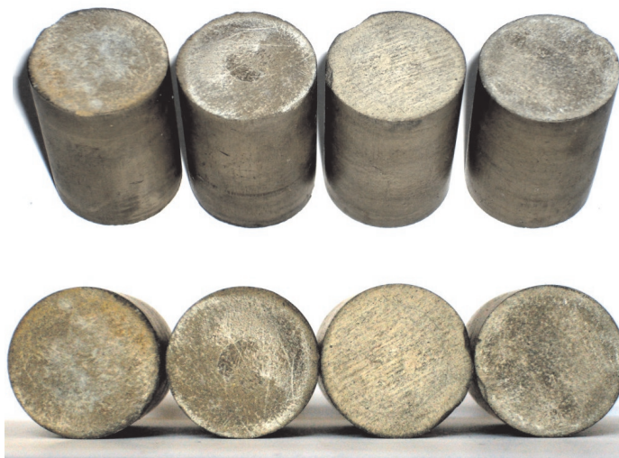
Rys. 6. Próbkę w kształcie walca o wysokości 2" i średnicy 1"
