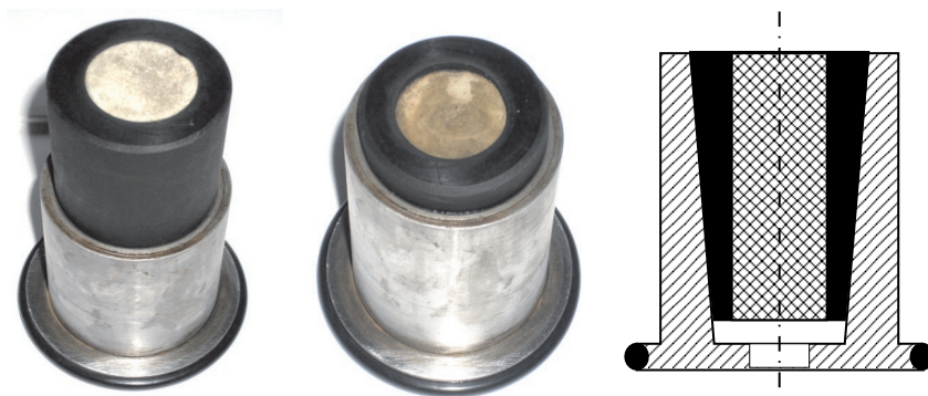
Rys. 8. Umieszczanie tulei z próbką w specjalnym zbieżnym cylindrze
