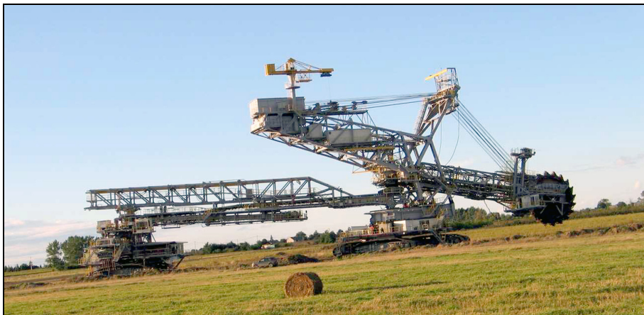
Rys. 1. Widok koparki SRs-1800 podczas transportu
