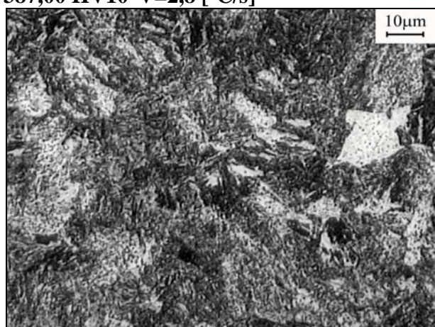
Rys. 79. Mikrostruktury próbek dylatometrycznych dla wytopu B2-V2-Ti1 po chłodzeniu z różnymi szybkościami
