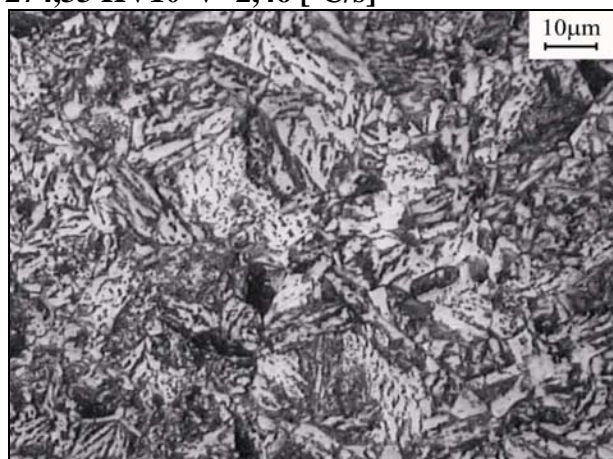
Rys. 75. Mikrostruktury próbek dylatometrycznych dla wytopu B-VI po chłodzeniu z różnymi szybkościami
