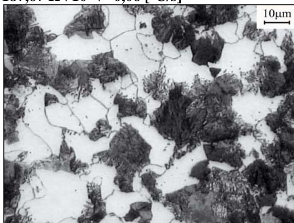
Rys. 73. Mikrostruktury próbek dylatometrycznych dla wytopu bazowego po chłodzeniu z różnymi szybkościami
