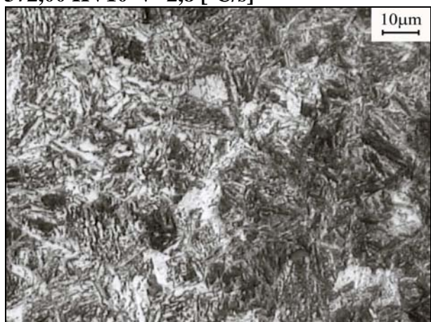
Rys. 73. Mikrostruktury próbek dylatometrycznych dla wytopu bazowego po chłodzeniu z różnymi szybkościami
