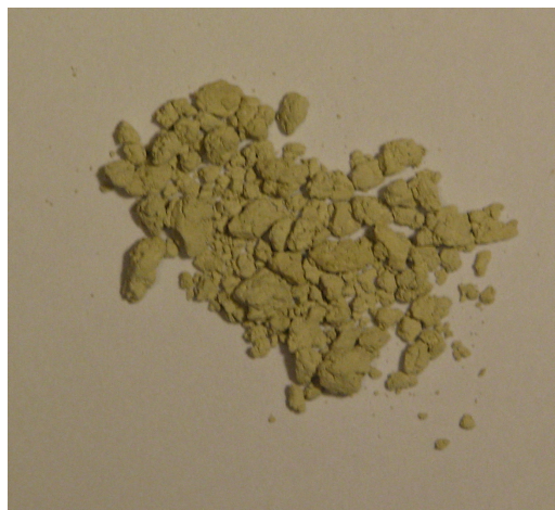
Rys. 14 Makroskopowy wygląd proszku srebra otrzymanego na drodze katodowej redukcji \text{AgCl} w ogniwie \text{Zn|H}_2\text{SO}_4, \text{AgCl|Ag}
