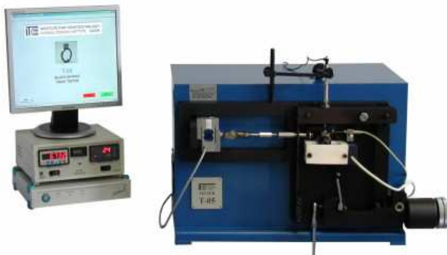
Rys. 7.2 Tester T-05 typu rolka – klocek do badań własności tribologicznych
