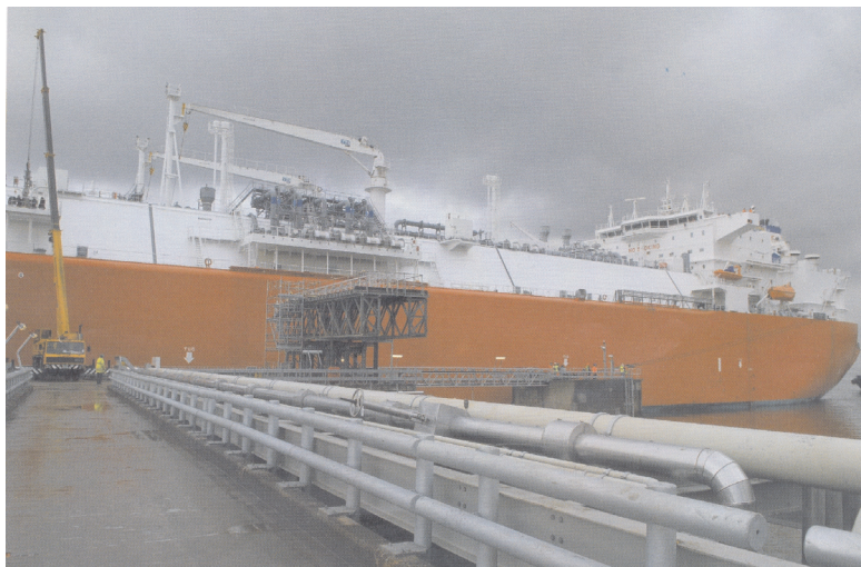
Rys. 2. Pierwsze regularne dostawy regazyfikowanego na pokładzie metanowca LNG, w ilości 5 mld m 3 /rok gazu ziemnego, do gazociągu lądowego w porcie Teesside w pñn.-wsch. Anglii, metodą „alongside moored ship” [5, 6]
