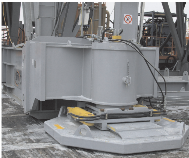
Rys. 12. Stopa systemu samokroczącego Drillmec 2000 HP Walking Rig [12]
