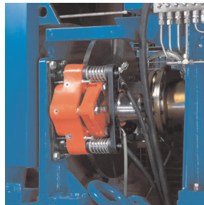
Rys. 8. Wielozaciskowe, bezpieczne w działaniu hamulce tarczowe z dwuobwodowymi hydraulicznymi układami sterowania [9, 10]
