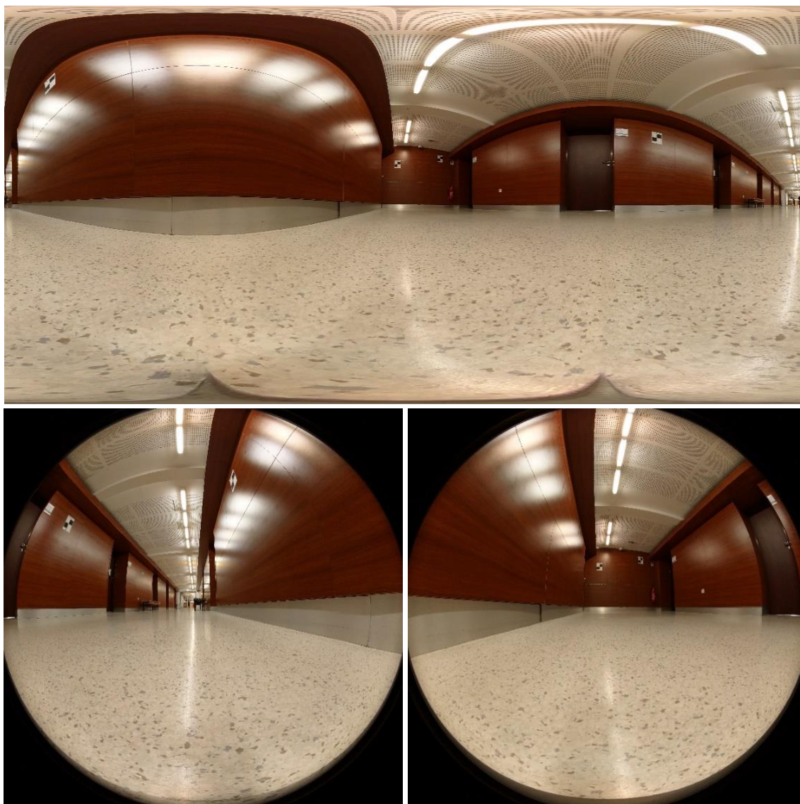
Rysunek 28. Przykład zastosowania wtyczki Theta bitrate do rozdzielania obrazu panoramicznego na obrazy fish-eye
