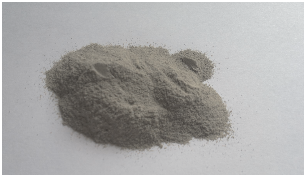
Rys. 2. Próbką środka do wypełniania wymienników otworowych Hekoterm
