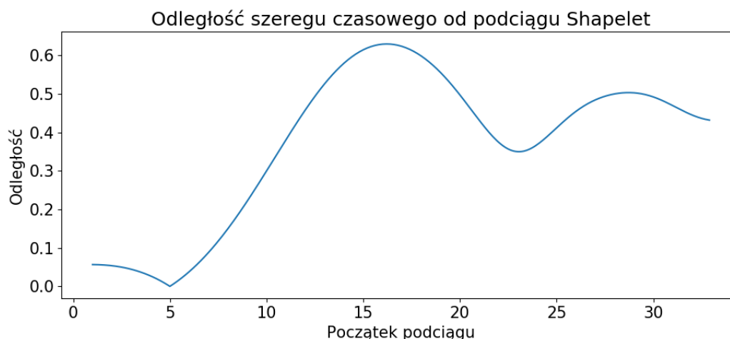
Rysunek 6.8: Wykres odległości między podciągiem Shapelet pokazanym na rysunku 6.7 a poszczególnymi podciągami szeregu czasowego (również pokazanego na rysunku 6.7). Odległość jest obliczana między stałym podciągiem Shapelet, a podciągiem rozpoczynającym się w danym punkcie czasu.
