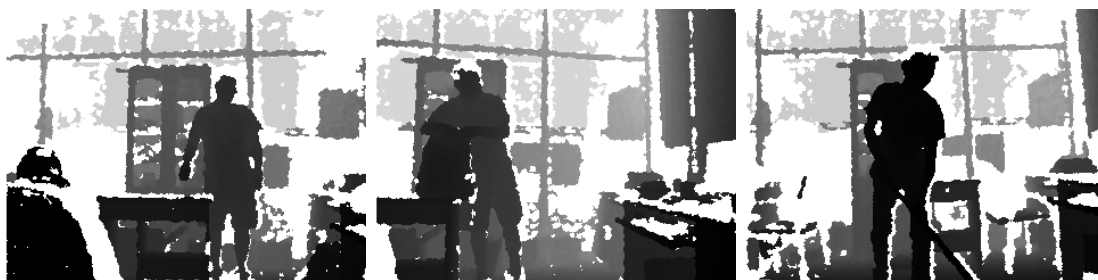
Rysunek 3.5: Przykładowe mapy głębi ze zbioru danych 3DHOI. Na zbiorach wykorzystywanych w badaniach eksperymentalnych, osoby zostały wydzielone ręcznie. Z każdej sekwencji wyodrębniono prostokąt zawierający wycinek mapy głębi, który następnie przeskalowano do rozmiaru wejścia sieci.
