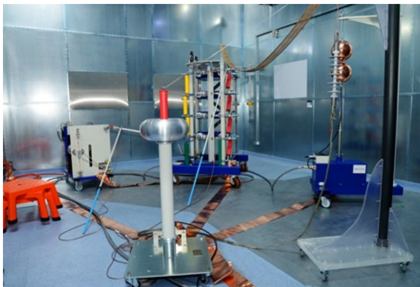
Wnętrze klatki Faradaya z generatorem napięć udarowych 400 kV w Laboratorium Nowych Technologii w Elektroenergetyce
