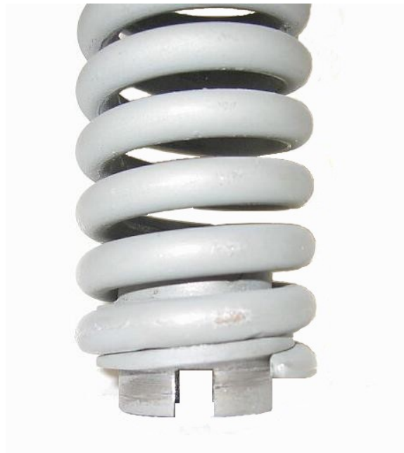
Rys.1.5. Mocowanie sprężyny we wkrętce
