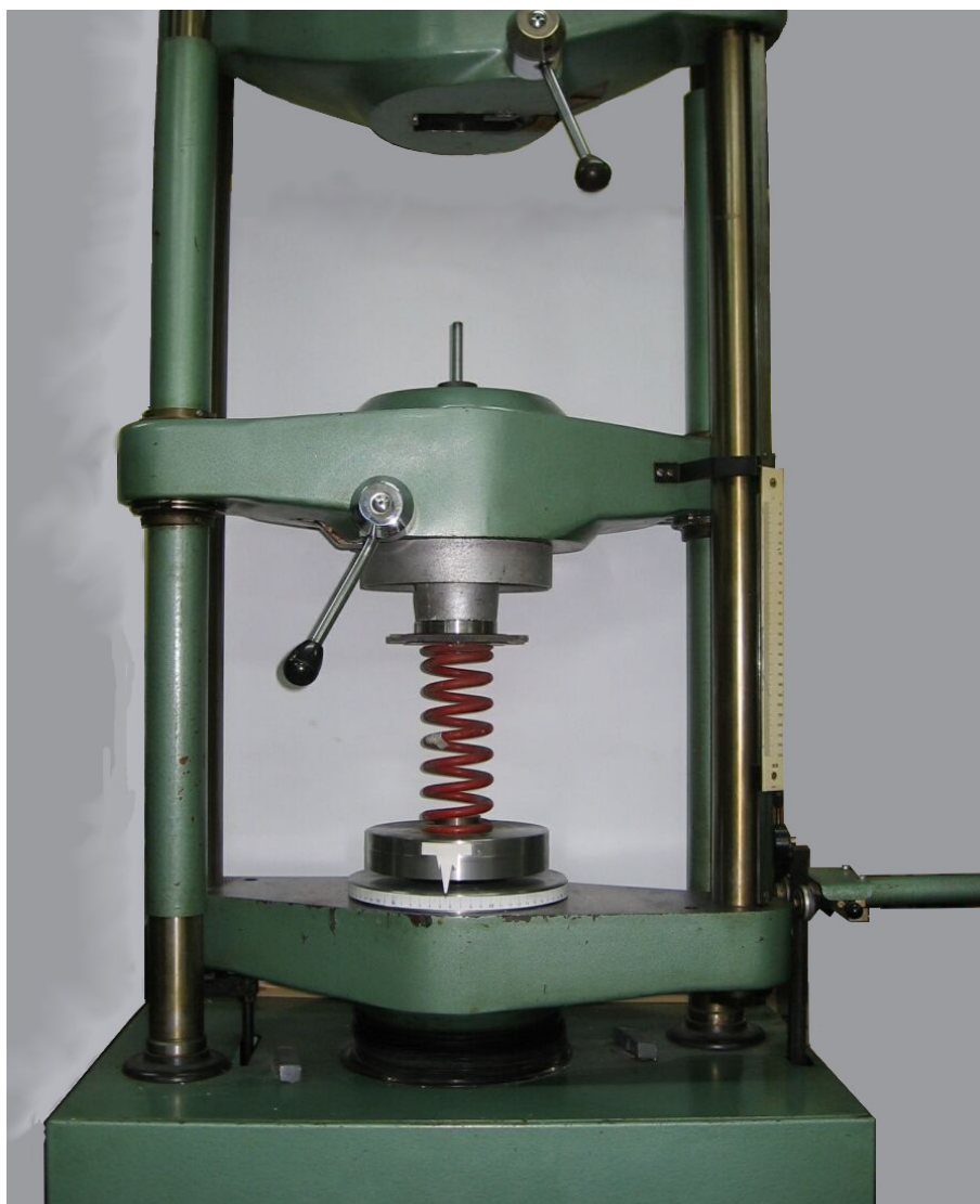
Rys.2.3. Stanowisko do badania kąta wzajemnego obrotu czół sprężyny
