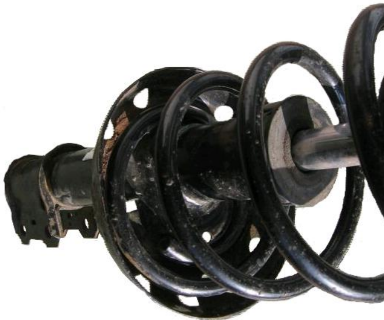
Rys.1.4. Mocowanie sprężyny na amortyzatorze przednim w samochodzie Opel Vectra
