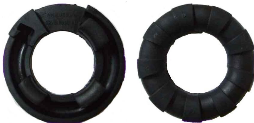
Rys.1.13. Gumowe podkładki, dostępne handlowo, stosowane pod sprężyny w przednim zawieszeniu samochodu Ford Transit
