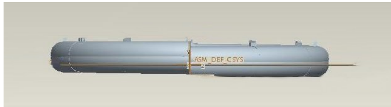
Rys.2.5. Uproszczony model sprężyny o dwóch zwojach i dyskretnym kącie skreńcenia równym 0,2 [^\circ]
