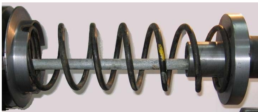
Rys.2.2. Badana sprężyna na stanowisku doświadczalnym
