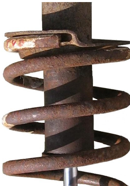
Rys.1.3. Mocowania na talerzu z kanałem prowadzącym o kształcie linii śrubowej
