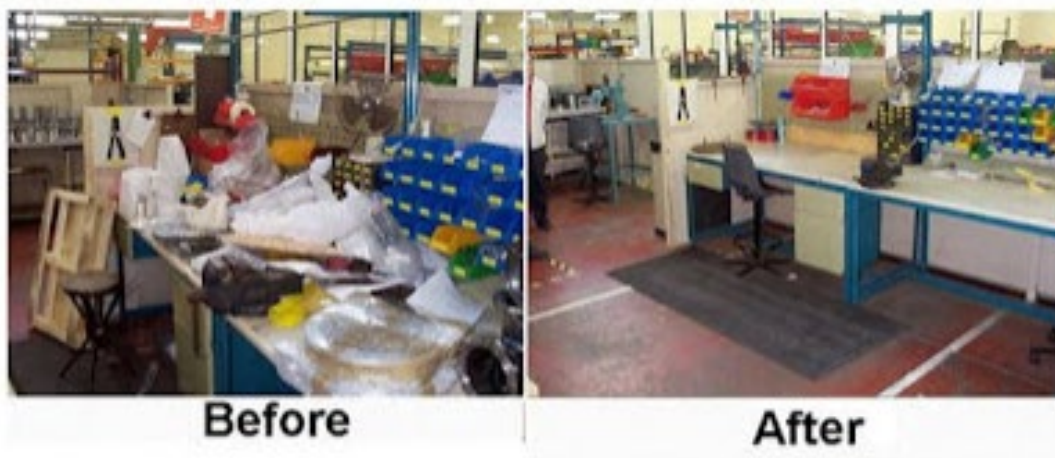
Rys 3.1 Stan przed i po wprowadzeniu 5S. Źródło: [14]
