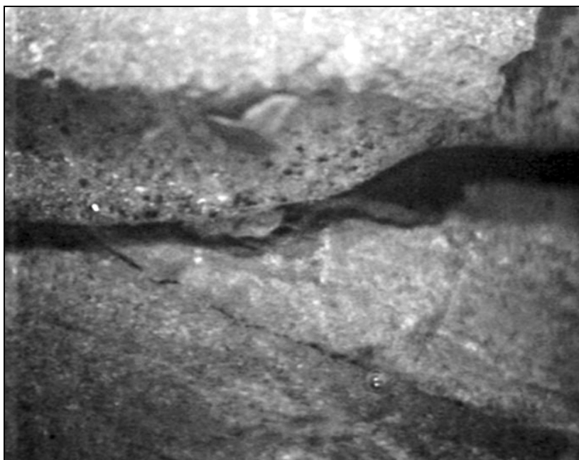
Rys. 2. Przykładowy obraz szczeliny w ścianie otworu wiertniczego
