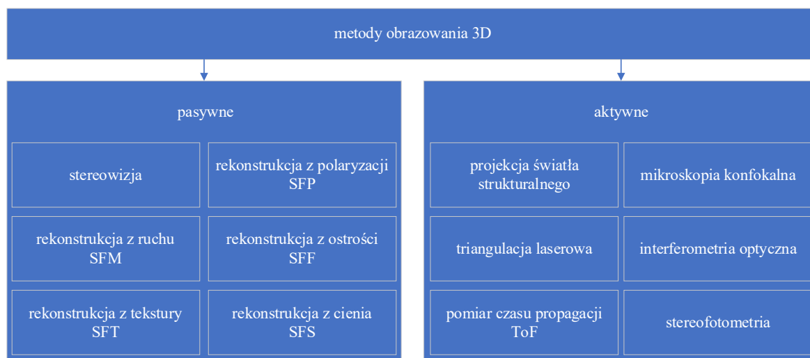
Rys. 1.1. Podział metod obrazowania trójwymiarowego [27]
