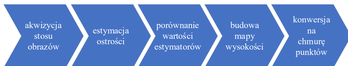
Rys. 4.1. Schemat przetwarzania danych w klasycznej metodzie SFF
