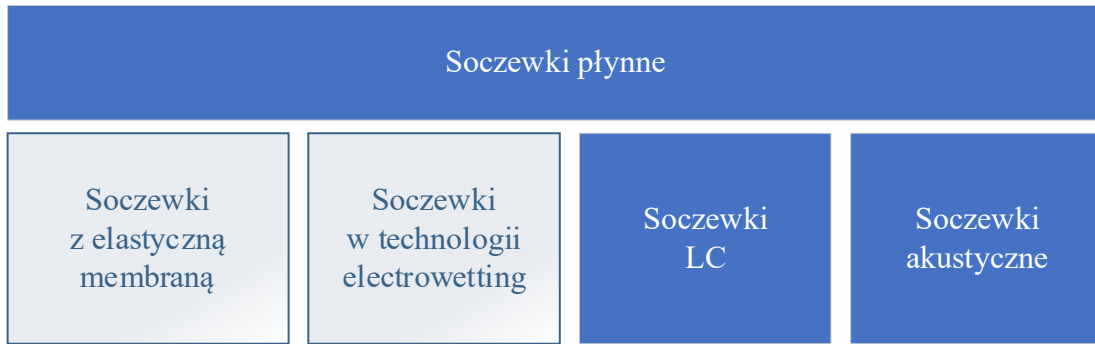
Rys. 5.3. Wiodące technologie soczewek płynnych
