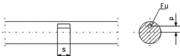
Rys. 5. Parametry wpływające na impuls indukowany w cewce [3]
