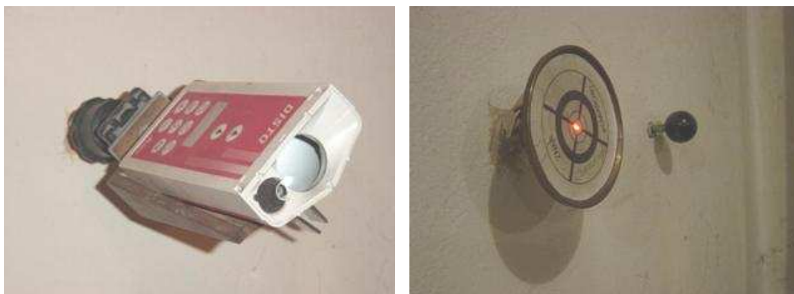
Rys. 3.14. Dalmierz laserowy i tarcza celownicza przymocowane do specjalnie zastabilizowanych znaków pomiarowych [www.chemkop.pl]
