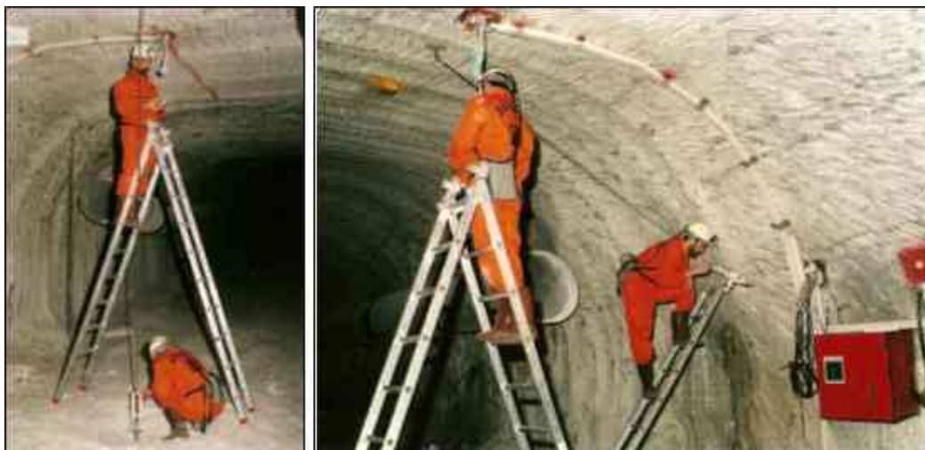
Rys. 3.1. Pośredni pomiar konwergencji liniowej przez pomiar długości baz [www.budokop.pl]
