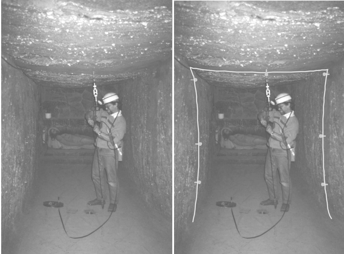
Rys. 2.1. Pomiar konwergencji w Kaplicy Św. Kingi w Bochni; charakterystyczny kształt zaciskanego wyrobiska solnego (fot. A. Maj)
