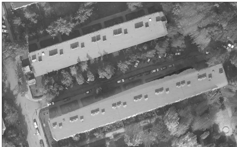
Rys. 6. Fragment ortofotomapy, przy której sporządzaniu do ortorektyfikacji wykorzystano NMPT
